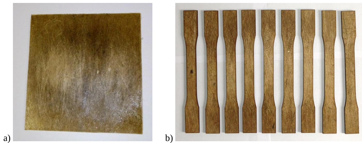
Figura 34 – Compósito com fibras de rami contínuas dispostas unidirecionalmente: a) placa e b) corpos de prova
