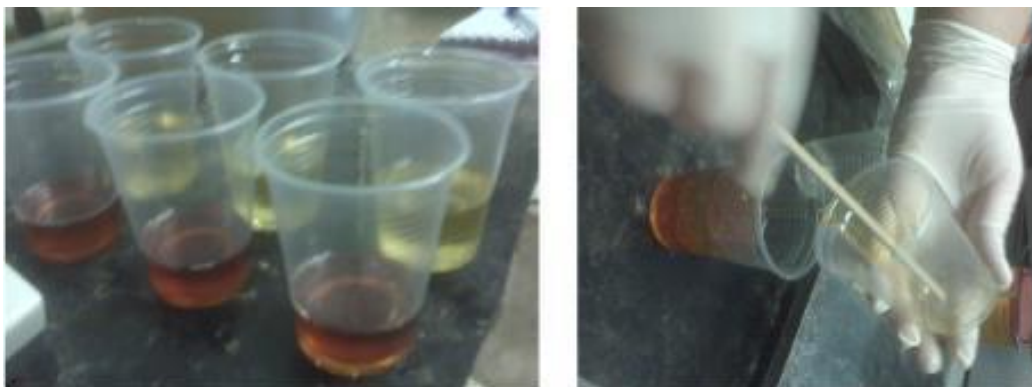
Figura 29 - Mistura dos componentes A e B
