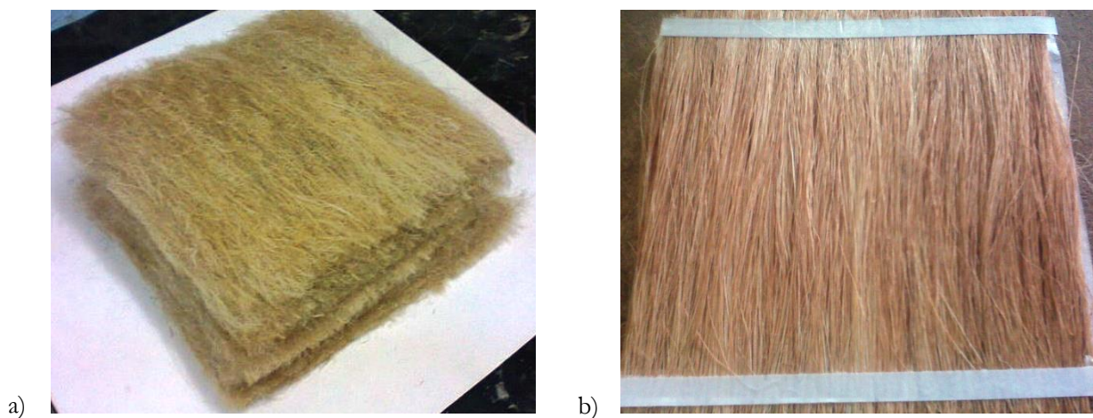
Figura 22 - Preparação das fibras contínuas unidirecionais: a) rami e b) sisal
