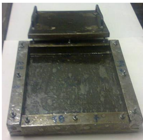
Figura 28 - Fôrmas metálicas utilizadas para moldagem dos compósitos
