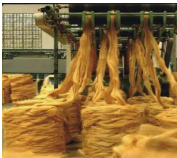
Figura 11 - Penteamento das fibras em batedeiras
