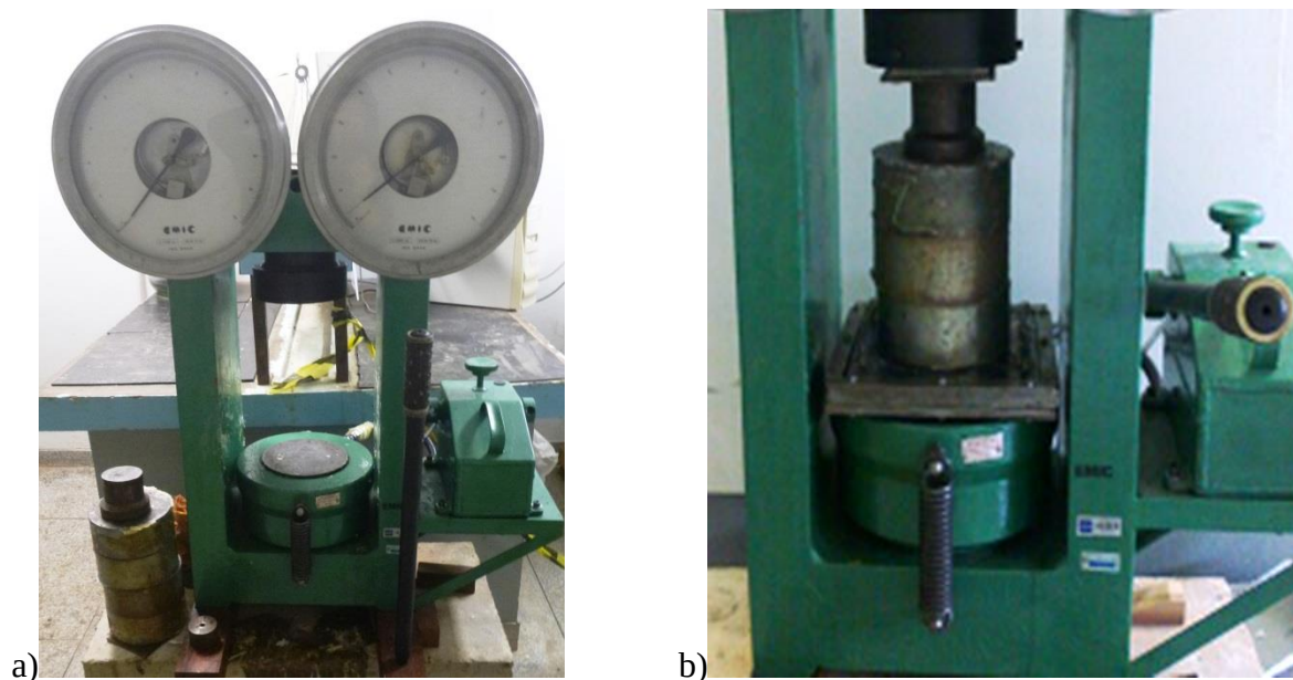
Figura 31 - Prensagem para produção do compósito: a) prensa hidráulica; b) fôrma prensada
