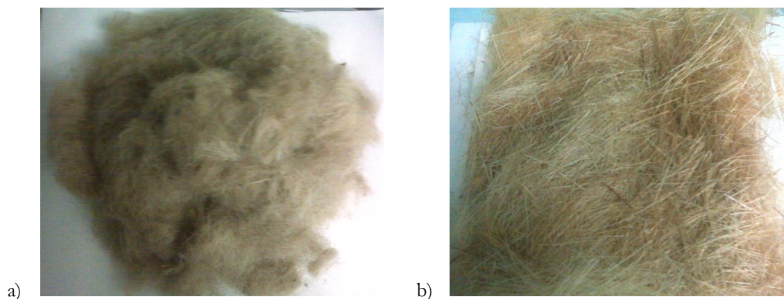
Figura 24 - Fibras descontínuas aleatórias: a) rami e b) sisal
