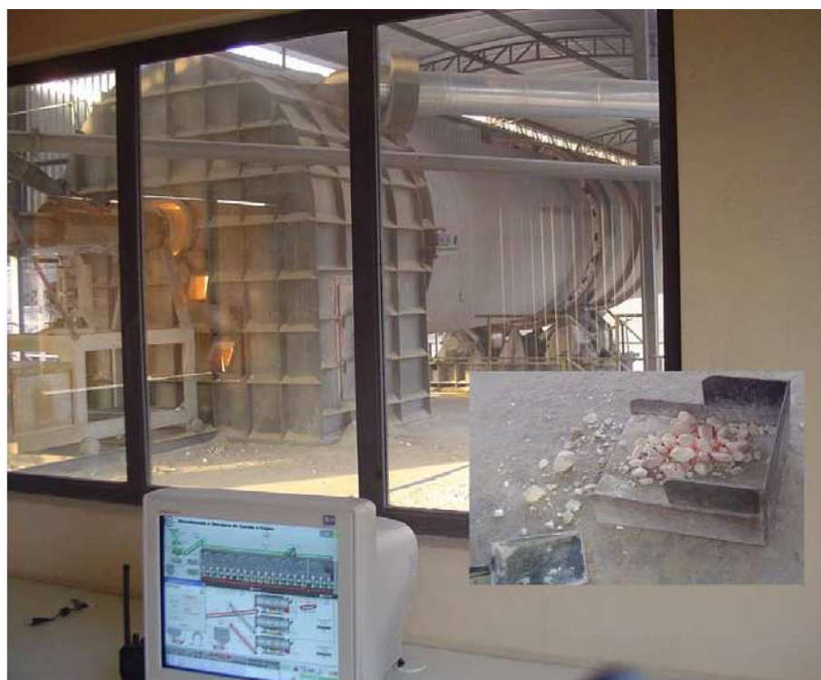
Figura 2.4 – Controle de qualidade realizado na Indústria de Cal Cruzeiro, dependente da experiência do operador (SOARES, 2007).
