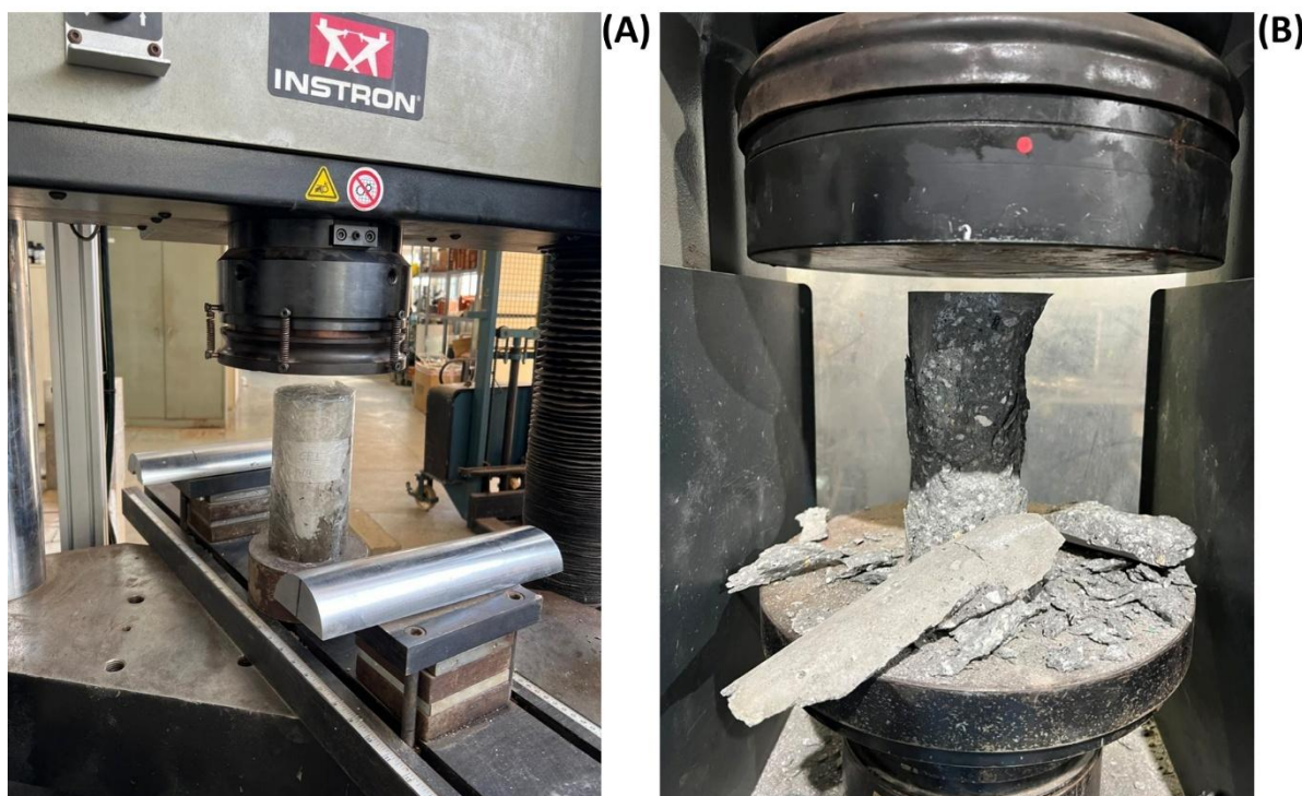
Figura 16 - Ensaio de compressão axial realizado na UFU e (B) o bloco após a ruptura realizado na PUC-Rio
