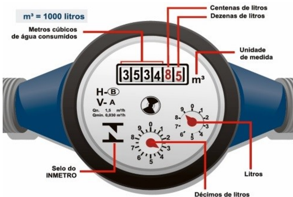
Figura 1 - Layout básico de um hidrômetro
