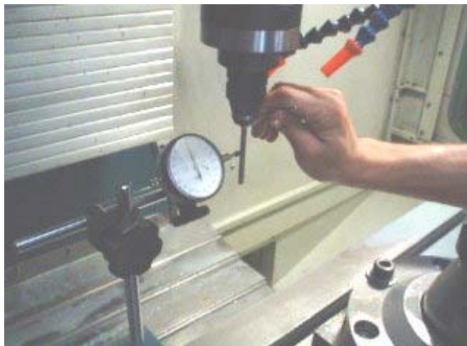
Figura 3.6 – Ajuste de batimento radial do alargador fixado à barra de mandrilar
