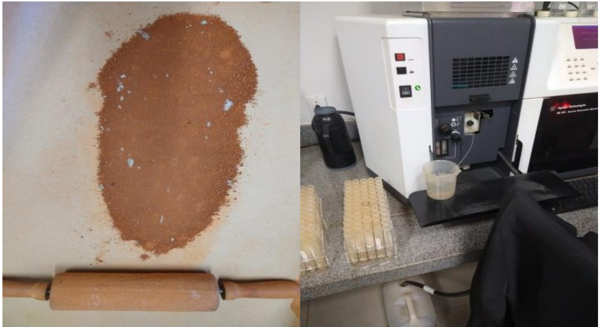
Figura 2. Detalhe da maceração das amostras para obtenção da Terra Fina Seca ao Ar (TFSA), quando observou-se fragmentos do micaxisto (esquerda), e espectrofotômetro utilizado na dosagem de K (direita).
