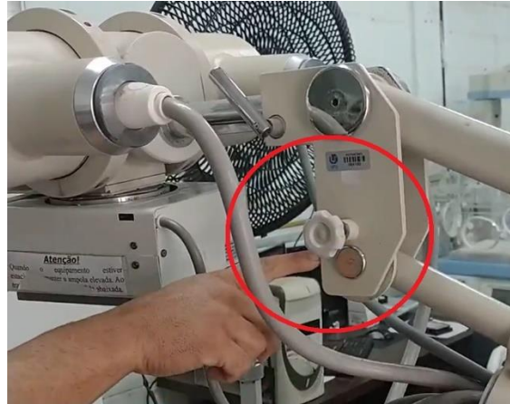
Figura 2: trava no topo do braço do equipamento
