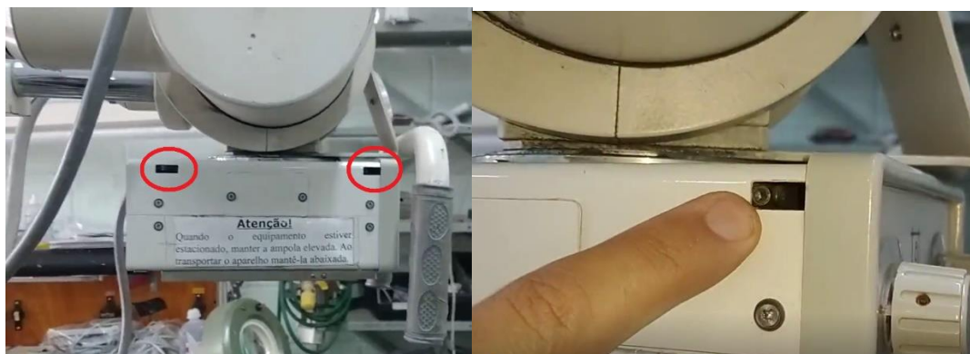
Figura 44: parafusos laterais que prendem o colimador
