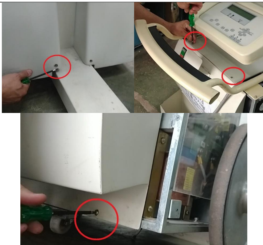
Figura 26: conjunto de imagens mostrando os parafusos que mantêm a superfície lateral do equipamento presa
