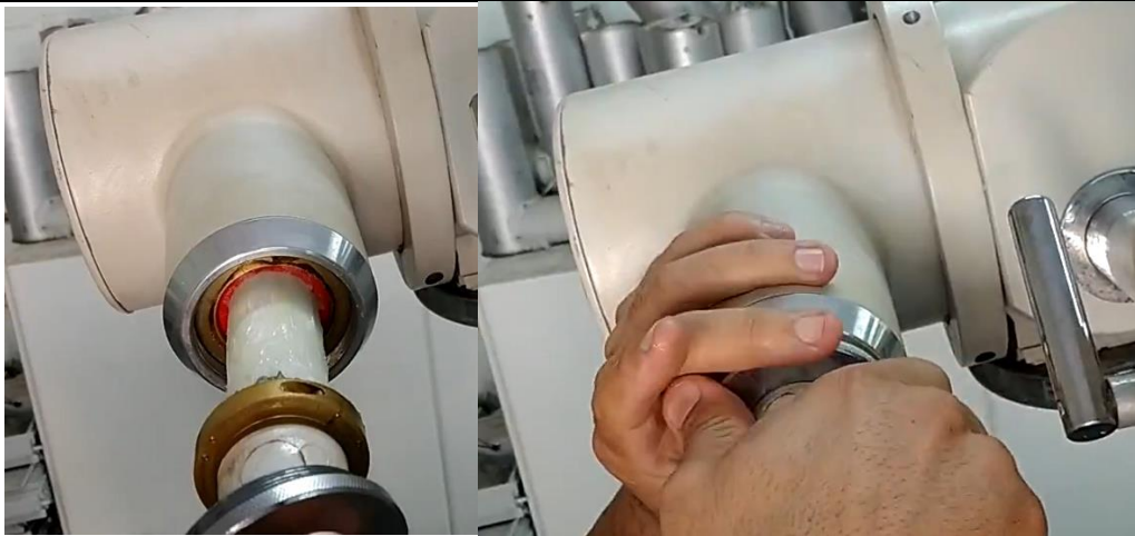
Figura 49: encaixando os eletrodos em sua posição
