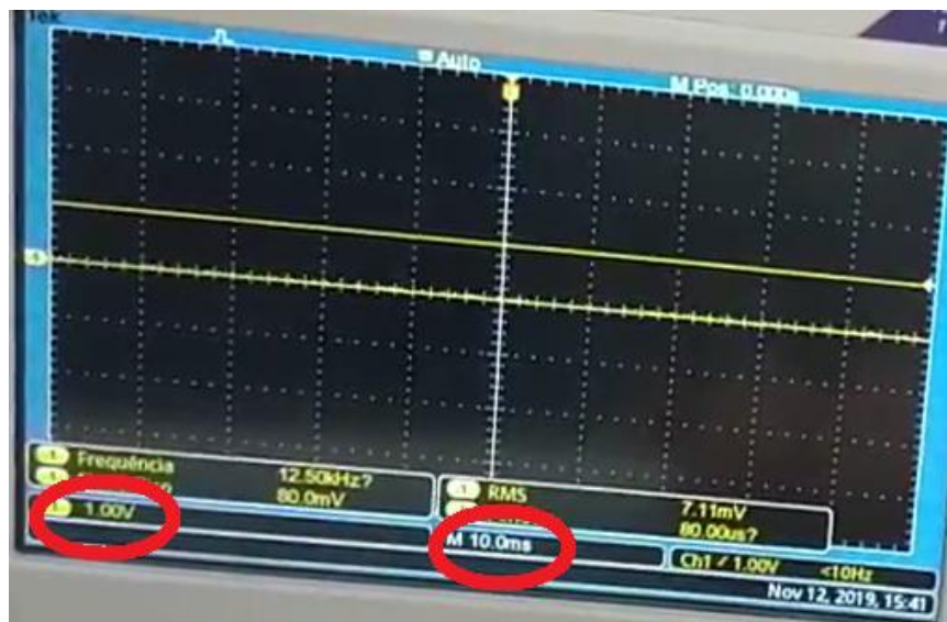
Figura 42: configuração ideal do osciloscópio para calibração do KV
