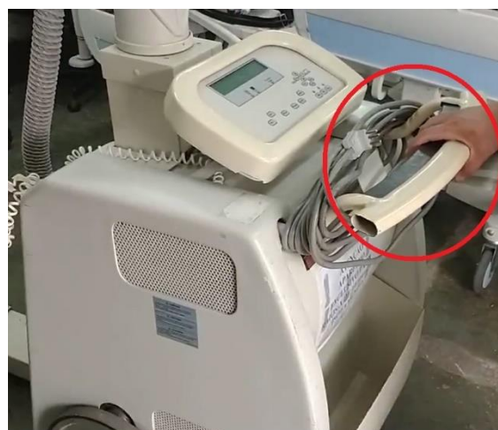
Figura 3: acionamento do freio manual
