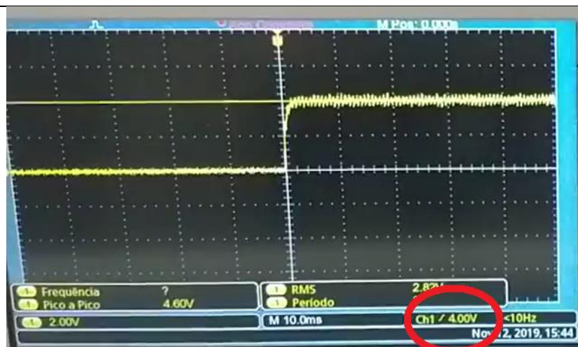
Figura 43: medida da tensão alcançada na calibração da kilovoltagem
