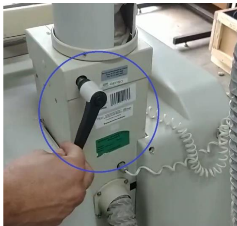
Figura 1: trava de segurança na base do braço
