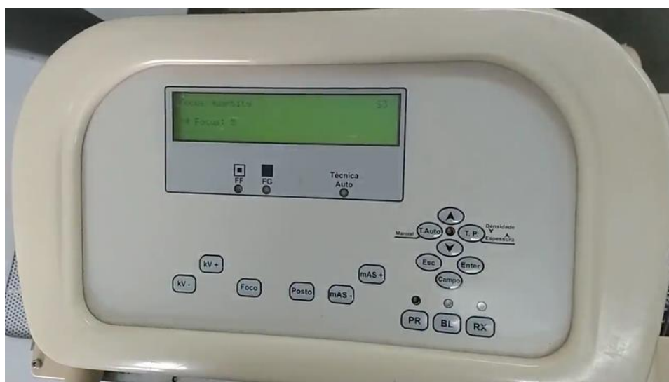
Figura 2: Painel de comandos com botões para controlar os fatores radiológicos
