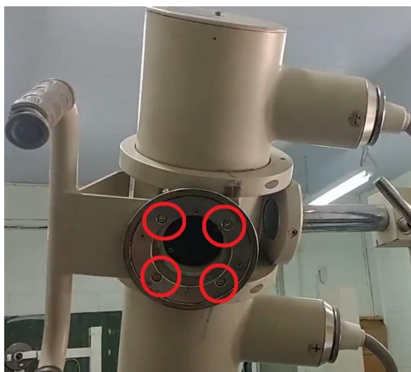
Figura 46: parafusos a serem apertados na verificação do colimador
