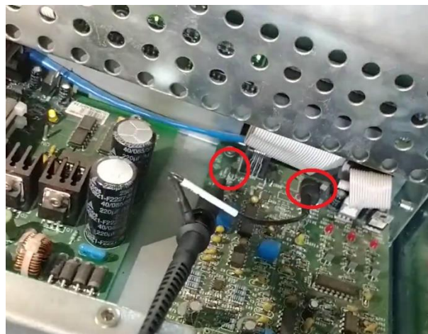
Figura 32: pontos da placa que levam a ponteira do osciloscópio
