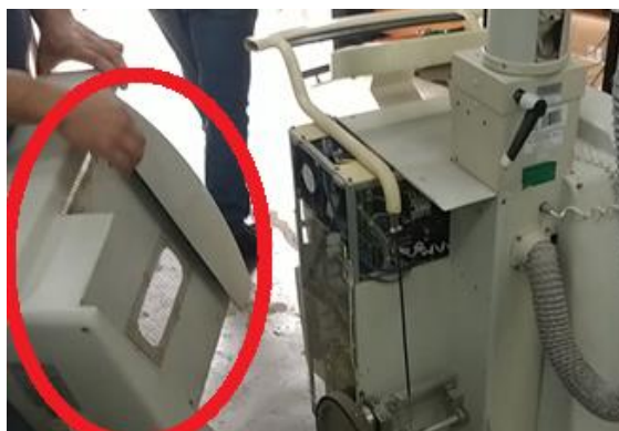
Figura 27: retirada da superfície lateral esquerda
