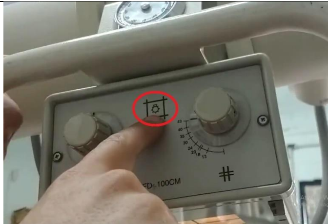
Figura 33: botão que liga a lâmpada do colimador
