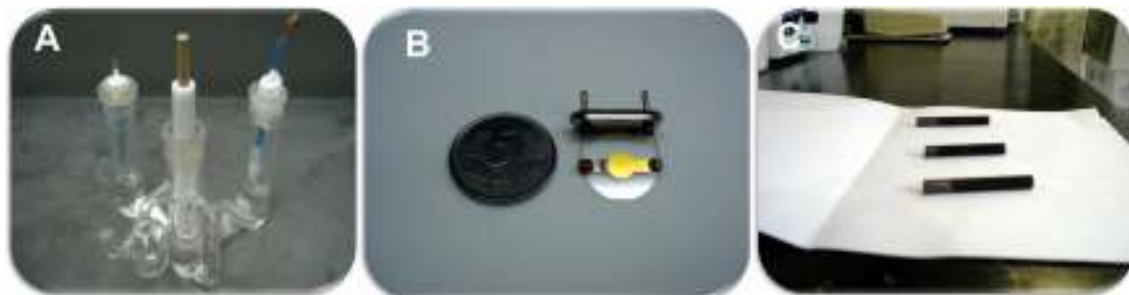
Figura 24: Materiais utilizados nos estudos com poli(4-HBA): (A) célula eletroquímica, (B) eletrodo de cristal de quartzo, (C) eletrodos cilíndricos de grafite.
