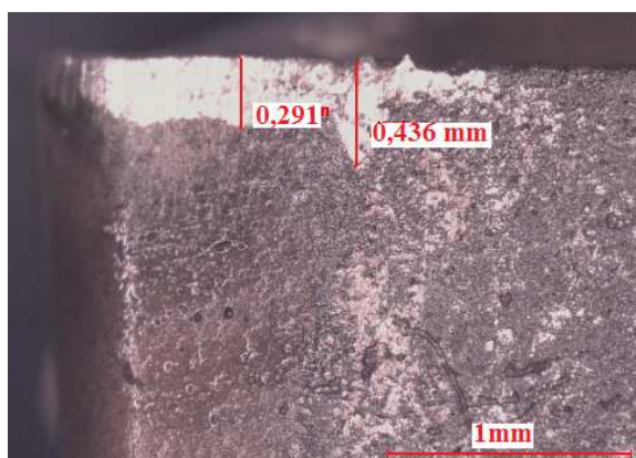
Figura 7.32e – Ferramenta após o décimo quarto ensaio da Aresta 4.
