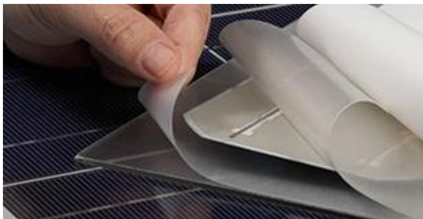
Figura - 6 Material encapsulante
