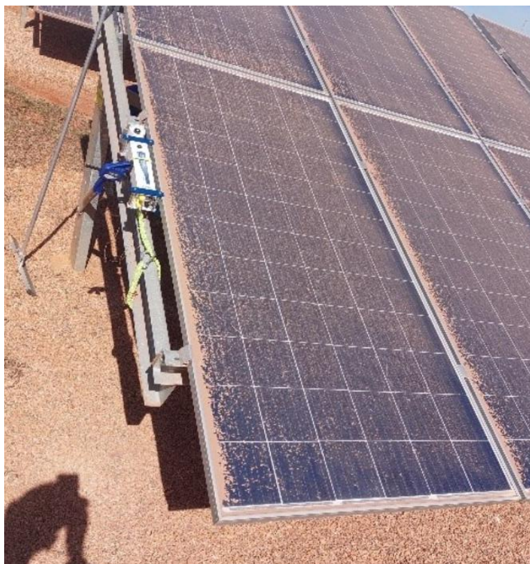
Figura 16 – Medição com módulo sujo
