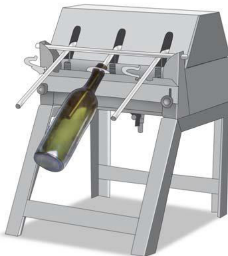
Figura 4. Máquina para engarrafamento do vinho.
