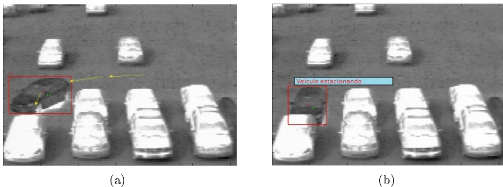
Figura 7.15: Exemplo da detecção do evento "Estacionar veículo" para a classe veículo .
