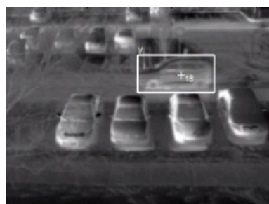
Figura 4.11: Classificação correta de um veículo pelo algoritmo.
