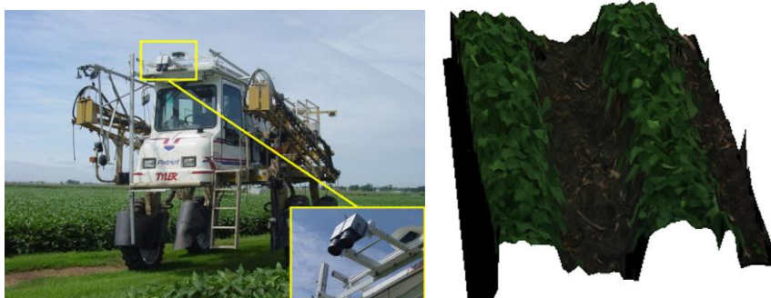
Figura 2.12 – Protótipo de Veículo usado como plataforma de teste com duas câmeras para captura das imagens e um exemplo da imagem virtual 3D obtida pelo método de visão estereoscópica (KISE e ZHANG, 2008).
