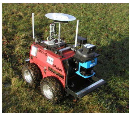
Figura 2.18 - Robô autônomo ATRV-jr de iROBOT usado para testes de Detecção de obstáculos (BLACKMORE et al., 2004).
