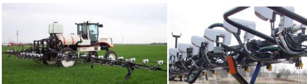
Figura 3.4. - Exemplo de Sistema de dosagem comercial de injeção direta para adubos (INTA, 2011).
