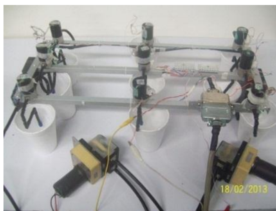
Figura 7.23. Estrutura de dosagem construída na escala 1:3 para validação funcional.
