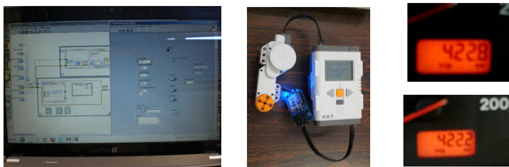
Figura 6.6. Testes de comunicação Xbee com acionamento remoto do motor pelo controlador NXT® no ambiente aberto.
