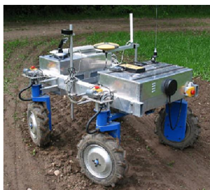
Figura 2.14 –Robô autônomo guiado por GPS-RTK para mapeamento e detecção das ervas daninhas. (SLAUGHTER et al., 2008).
