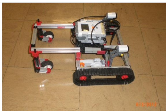
Figura 5.17. Protótipo de veículo construído na escala de 1:3 para validação do sistema de deslocamento e controle.
