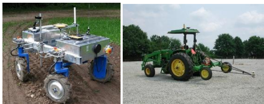
Figura 3.1 – Esquerda: Desenho específico de veículo protótipo (SLAUGHTER et al., 2008); Direita: Veículo comercial tipo trator modificado (GAN-MOR et al., 2007).
