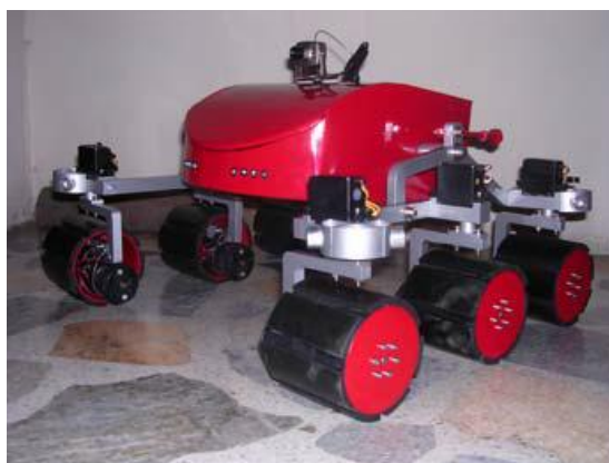
Figura 2.20 – Robô tipo rover “DIDAJÓ” desenvolvido pela Universidade San Buenaventura de Bogotá, Colombia (ARDILA et al., 2006).
