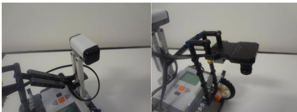
Figura 5.7. Sensor comercial tipo bússola (esquerda) e Câmera NXT Cam-v3 (direita).
