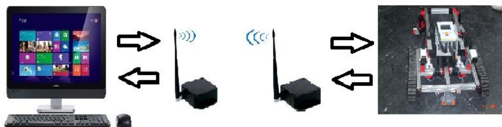
Figura 6.1. Arquitetura de comunicação sem fio utilizada: um dispositivo transmissor-receptor ligado ao computador, além de um dispositivo ligado ao veículo.
