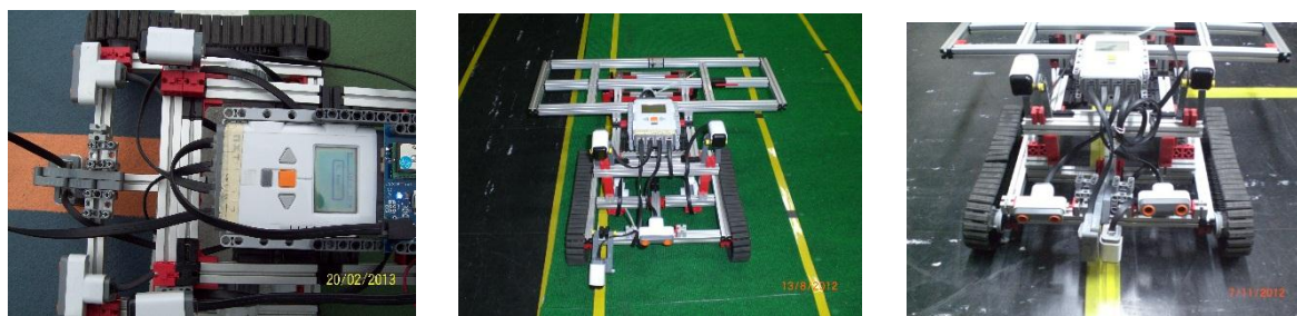
Figura 5.19. Imagens do processo de seguimento da linha de cor. Do lado esquerdo é mostrada a calibração do sensor de cor, no centro, testes com um sensor de cor e na direita os testes com dois sensores de cor.
