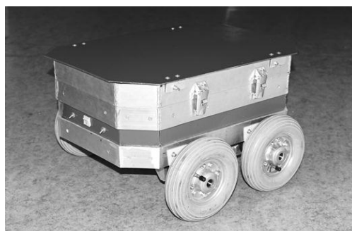
Figura 2.16 – Plataforma robô modular INDIGO para cargas maiores que 80 kg (STERNFELD et al., 2005).
