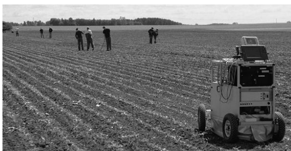
Figura 2.15 – Robô para detecção das ervas daninhas pela análise de imagens. (ÂSTRAND e BAERVELDT, 2002).
