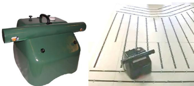
Figura 2.10 – Pequeno Robô Móvel de teste – Small Movel Robot –SMR e pista de teste usada na avaliação do estudo (JORGENSEN et al. 2008).
