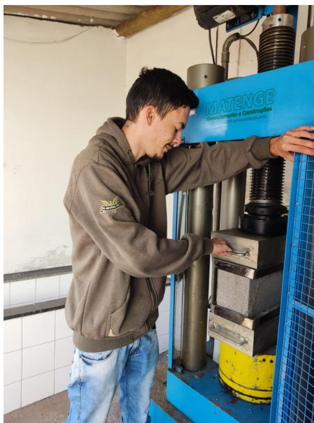
Figura 7 - Preparação para o rompimento do bloco
