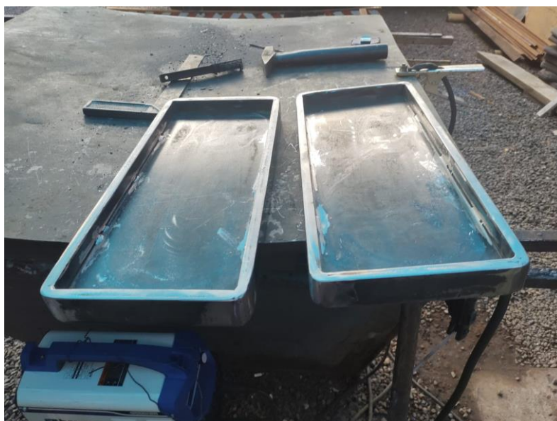
Figura 6 - Fôrmas de aço
