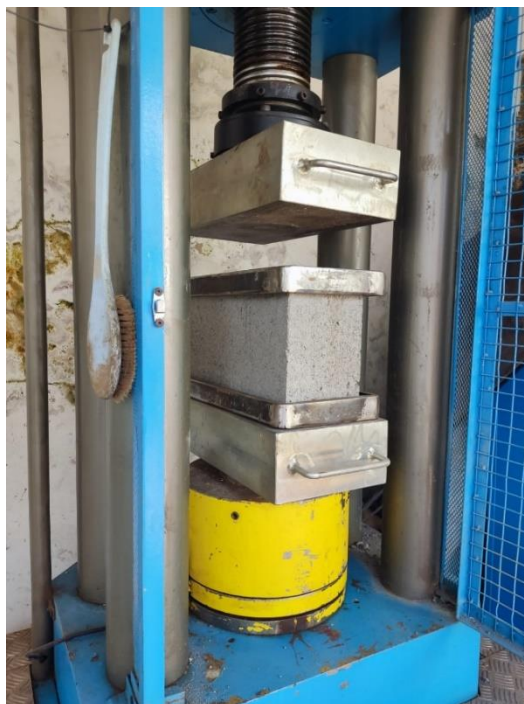
Figura 8 - Rompimento de bloco capeado com Neoprene
