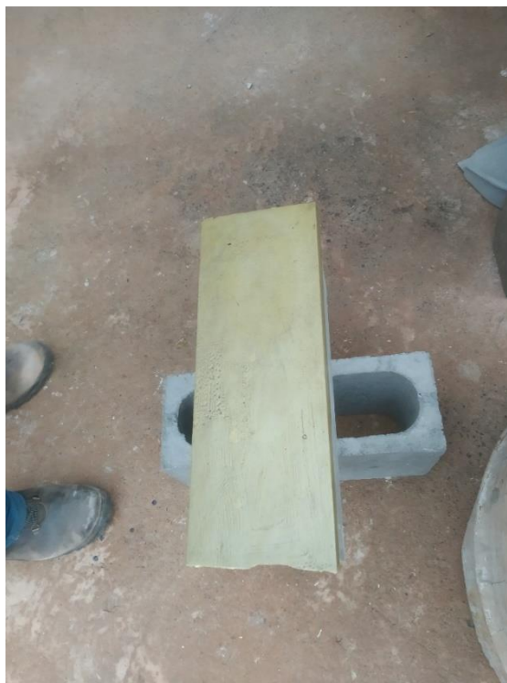
Figura 4 - Bloco capeado com enxofre vista superior
