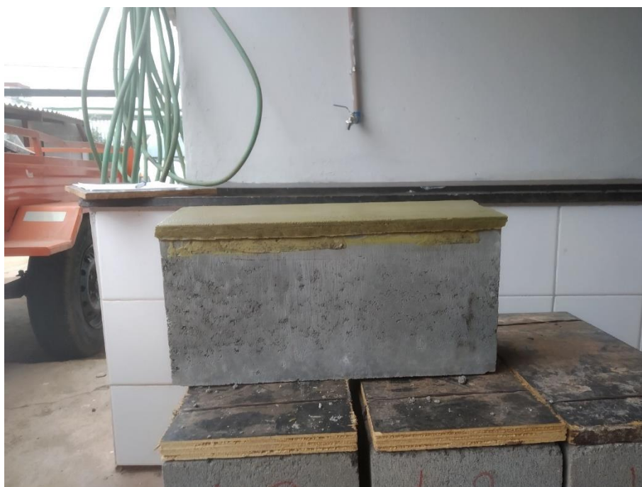
Figura 3 - Bloco capeado com enxofre: vista lateral
