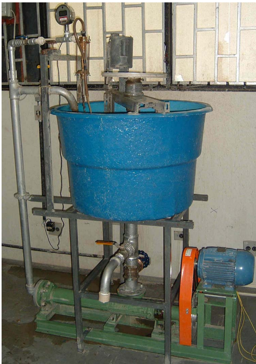
Figura 3.9 – Unidade Experimental para o estudo de hidrociclones
