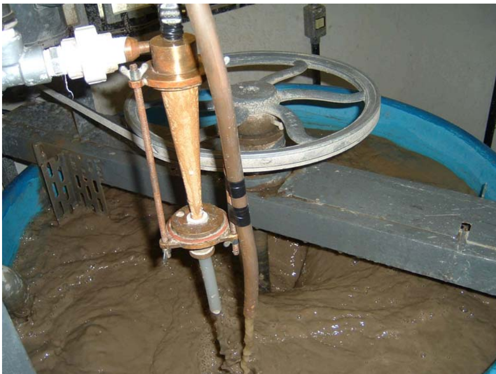
Figura 3.11 – Sistema de homogeneização do tanque e um hidrociclone filtrante em funcionamento
