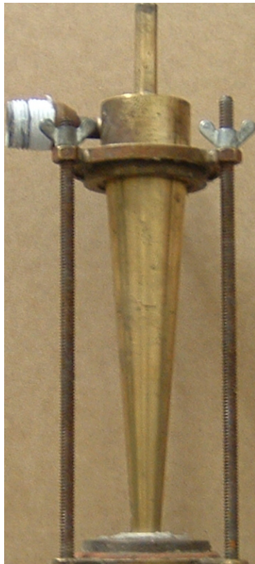
Figura 1.1 – Hidrociclone (a) e seu esquema (b) com as principais dimensões de projeto.
