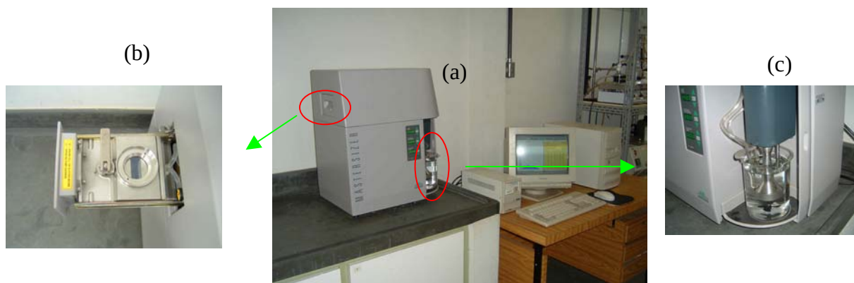
Figura 3.12- Mastersizer (a), compartimento de análise (b) e sistema de agitação e bombeamento (c)
