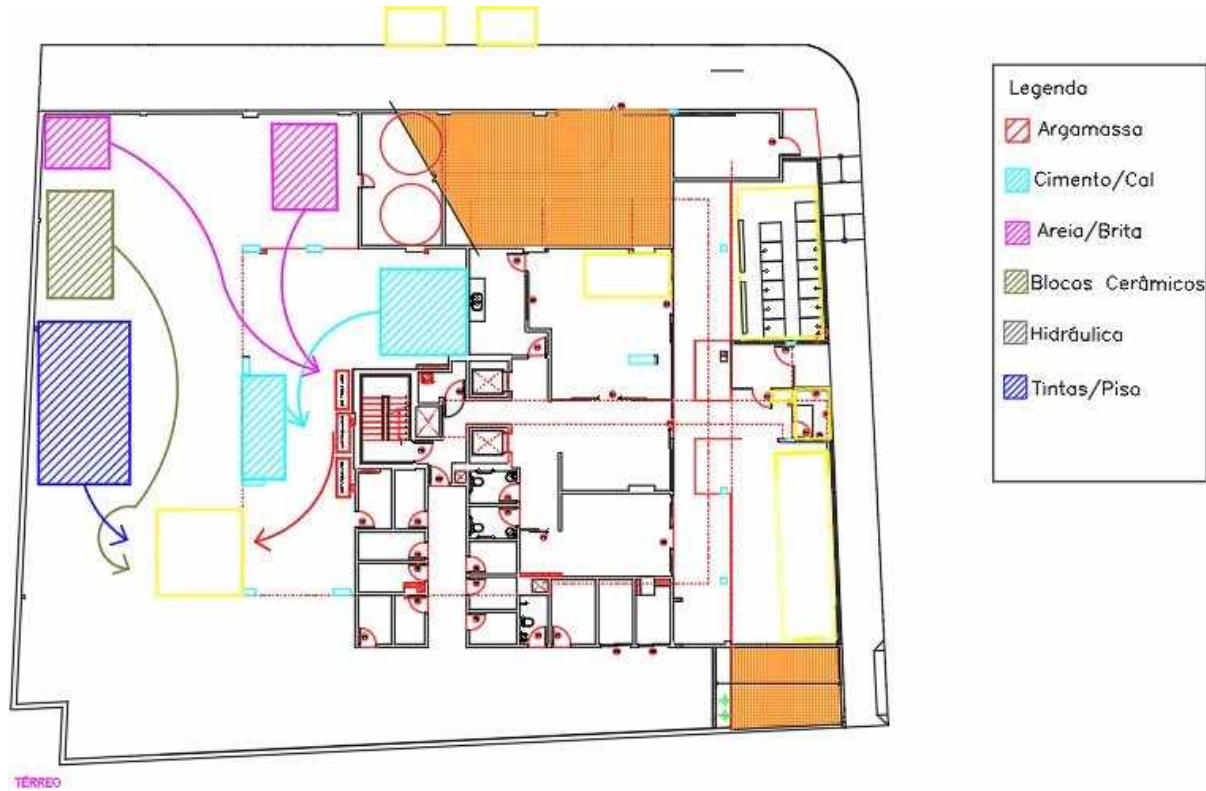
Figura 37 – Fluxo de materiais no canteiro referente a fase 7
