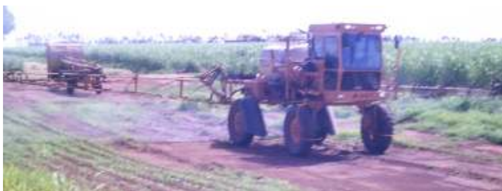
Foto 9 – Iturama/MG: Trator Bomba Utilizado para Aplicação de Insumos nas Lavouras Autor: CARVALHO, E. R., abr./2008.
