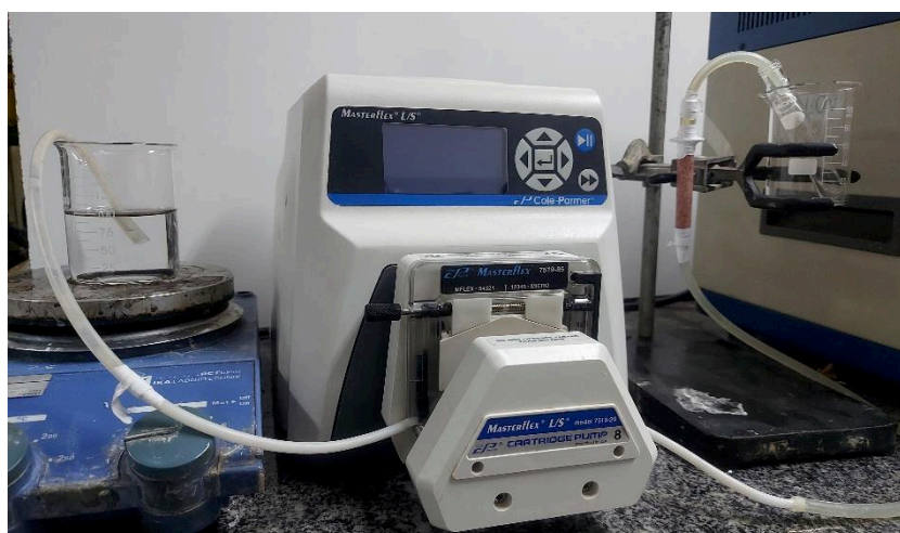
Figura 3.10 - Unidade experimental para síntese de GOS em coluna de leito fixo, coluna 1.
