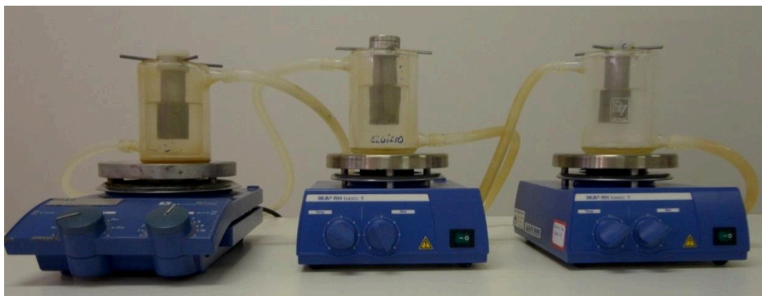
Figura 3.5 - Unidade Experimental para determinação da atividade da enzima imobilizada
