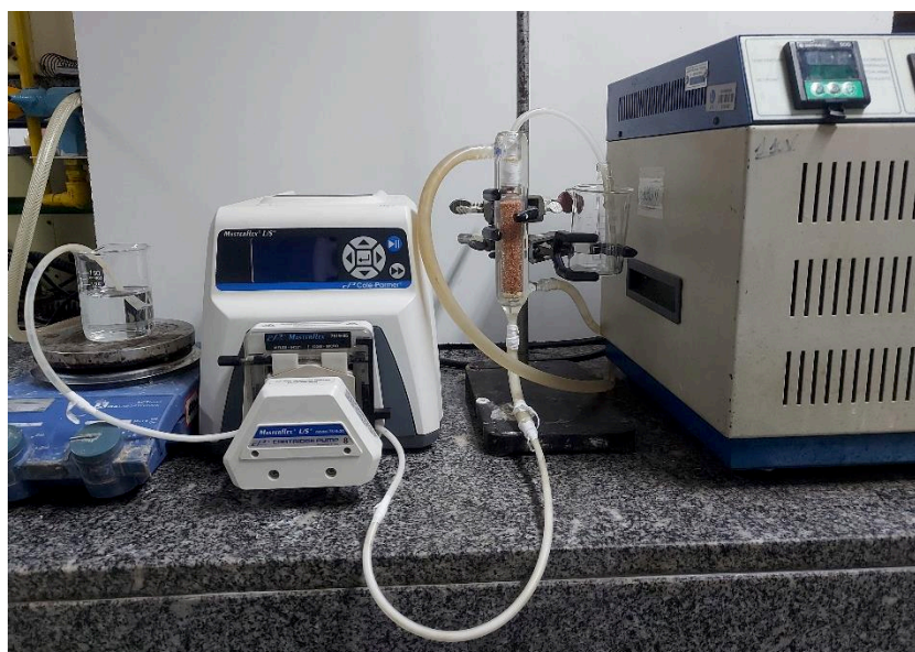
Figura 3.11 - Unidade experimental para síntese de GOS em coluna de leito fixo, coluna 2.
