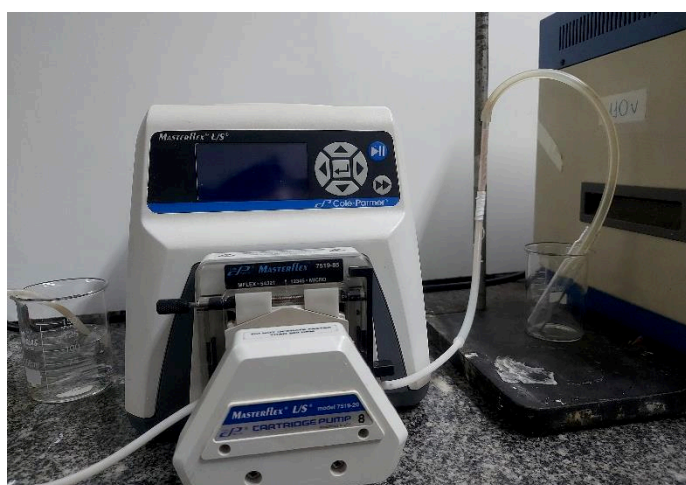
Figura 3.8 - Unidade experimental para hidrólise da lactose em leito fixo
