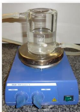
Figura 3.4 - Unidade Experimental para determinação da atividade enzimática para enzima solúvel
