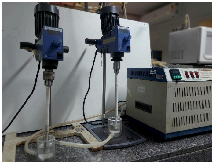
Figura 3.9 - Unidade experimental para síntese de GOS com agitação mecânica
