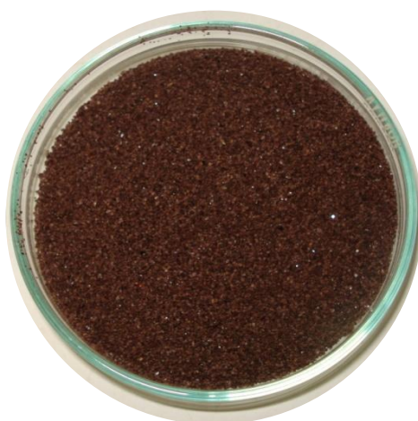
Figura 4.2 – Resina Duolite A-568 empregada para imobilização da enzima \alpha -galactosidase.
