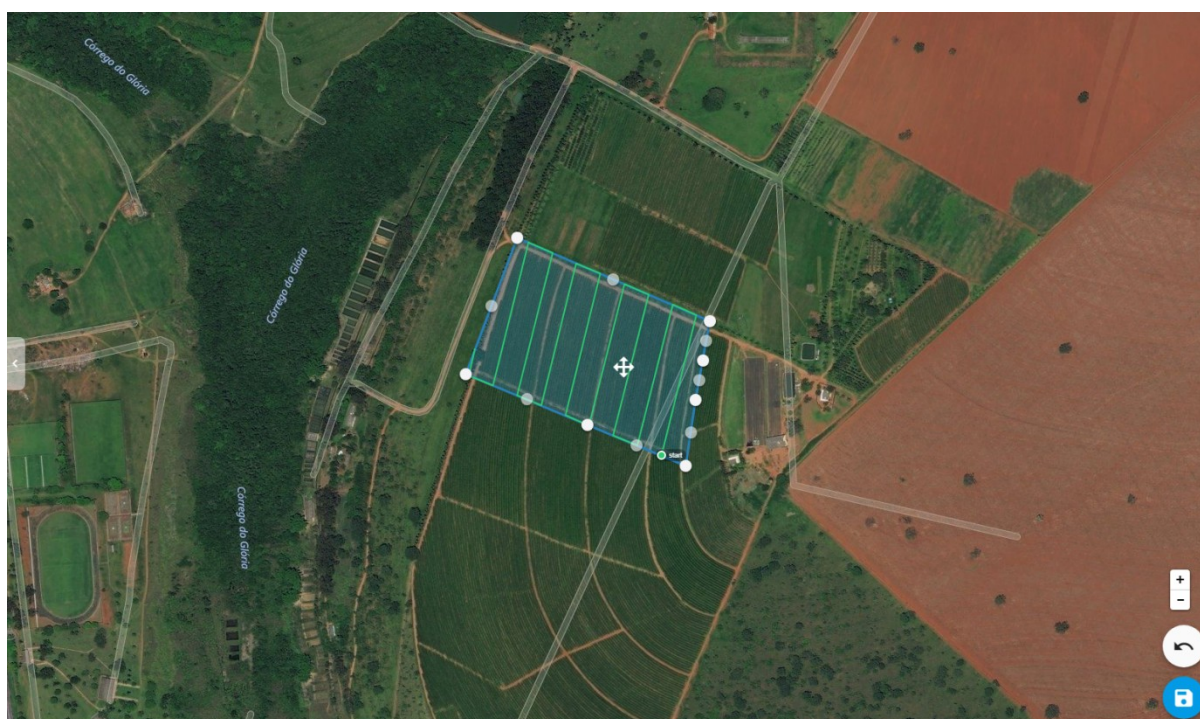
FIGURA 2. Polígono do voo autônomo ilustrado no software DroneDeploy .
