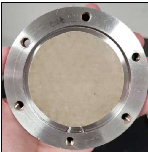
Figura 13 – Membrana revestida com OG/EDA acoplada no módulo de filtração
