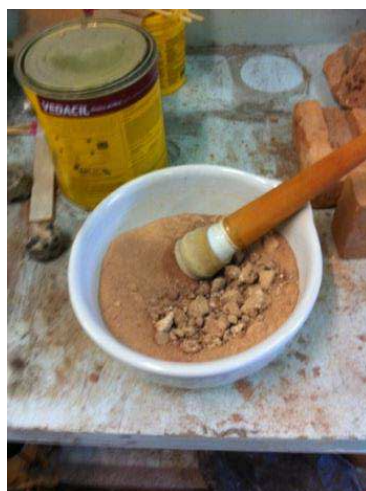
Figura 24 – Almofariz e mão de gral para desmanchar os torrões
