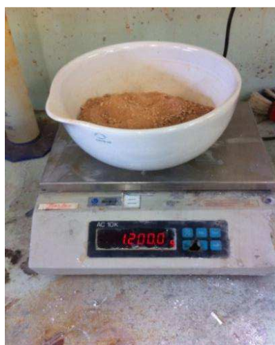
Figura 25 – Seleção exata da quantidade de argamassa a peneirar
