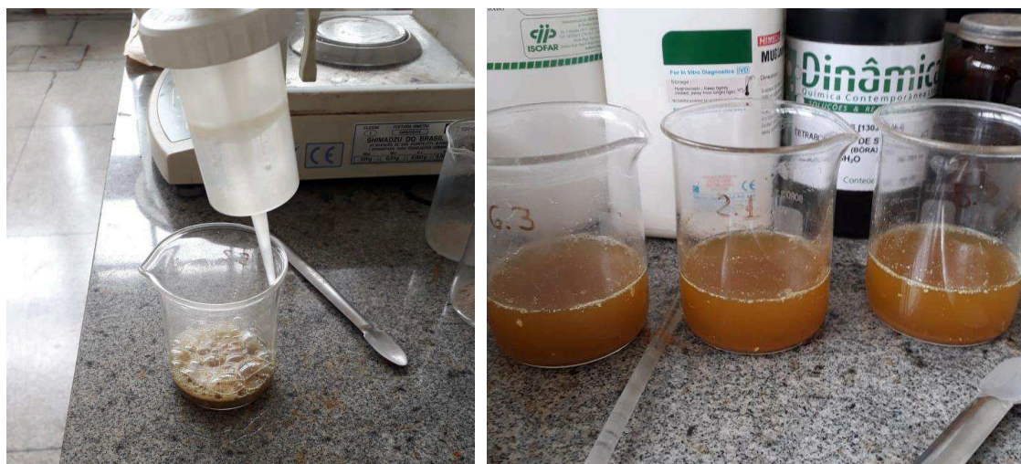
Figura 21 – Adição de HCl (1:2).
