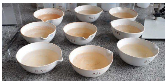
Figura 31 – Cápsulas de porcelana para sais solúveis da argamassa de argila.
