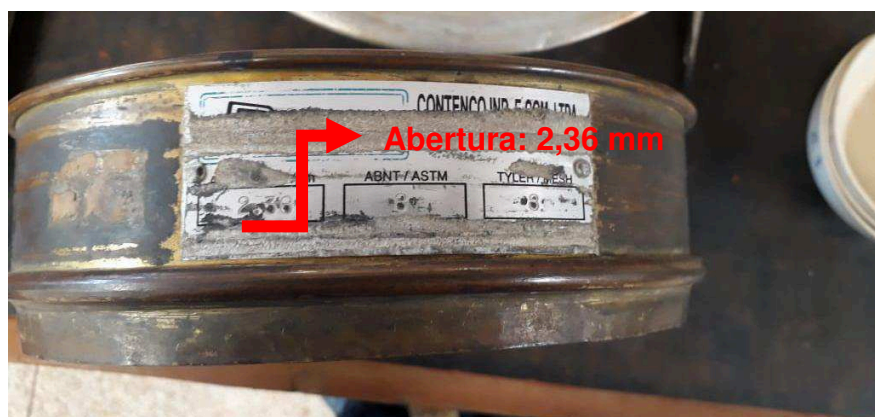
Figura 15 – Peneira de 2,36 mm de abertura.
