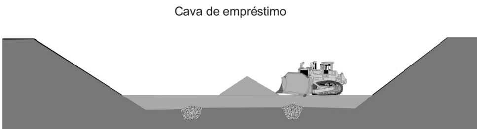
Figura 52: Aterramento da cava com resíduo de construção civil.
