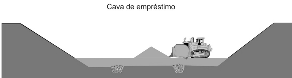
Aterramento da cava com resíduo de construção civil.
