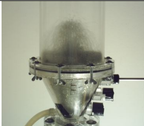
Figura 4.27 – Condição experimental com a sonda localizada no centro do leito de jorro, velocidade do ar de 33 m/s e altura da fonte detectada de 7,5 cm.
