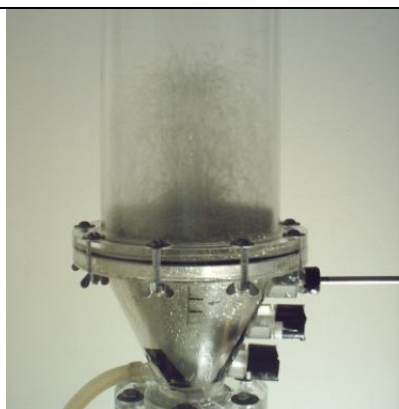
Figura 4.37 – Condição experimental com a sonda localizada a 0,5 cm do centro do leito de jorro, velocidade do ar de 36 m/s e altura da fonte detectada de 11,5 cm.
