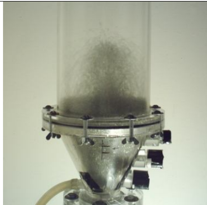
Figura 4.25 – Condição experimental sem a introdução da sonda, velocidade do ar de 33 m/s e altura da fonte detectada de 9,5 cm.
