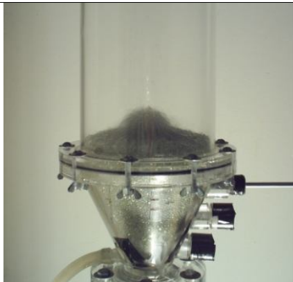
Figura 4.11 – Condição experimental com a sonda localizada no centro do leito de jorro, velocidade do ar de 27 m/s e altura da fonte detectada de 2,0 cm.
