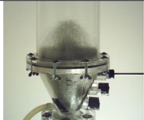
Figura 4.21 – Condição experimental com a sonda localizada a 0,5 cm do centro do leito de jorro, velocidade do ar de 30 m/s e altura da fonte detectada de 6,5 cm.
