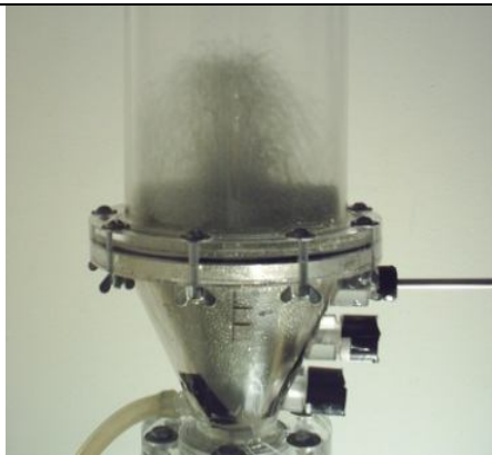
Figura 4.35 – Condição experimental com a sonda localizada no centro do leito de jorro, velocidade do ar de 36 m/s e altura da fonte detectada de 10 cm.
