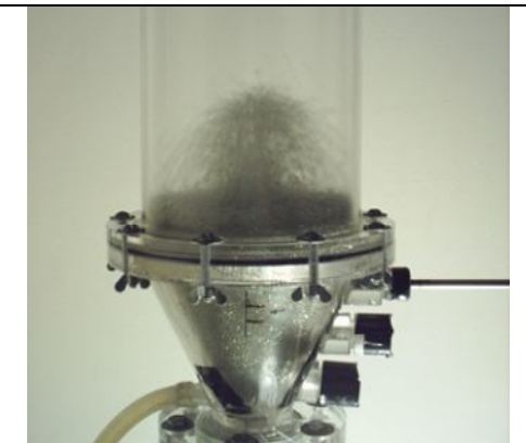
Figura 4.23 – Condição experimental com a sonda localizada a 1 cm do centro do leito de jorro, velocidade do ar de 30 m/s e altura da fonte detectada de 7,0 cm.
