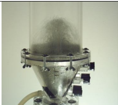
Figura 4.17 – Condição experimental sem a introdução da sonda, velocidade do ar de 30 m/s e altura da fonte detectada de 7,0 cm.
