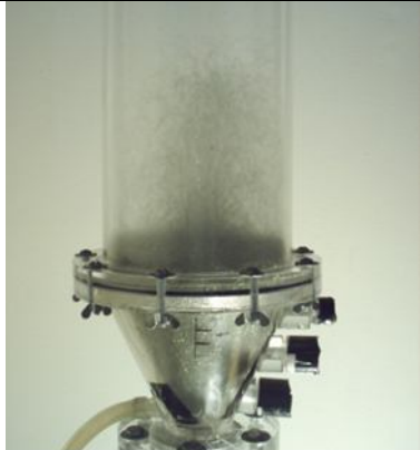
Figura 4.33 – Condição experimental sem a introdução da sonda, velocidade do ar de 36 m/s e altura da fonte detectada de 12 cm.
