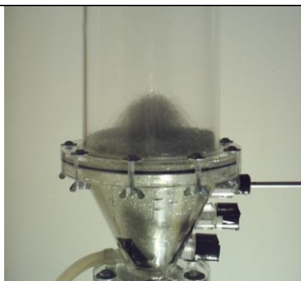
Figura 4.13 – Condição experimental com a sonda localizada a 0,5 cm do centro do leito de jorro, velocidade do ar de 27 m/s e altura da fonte detectada de 3,5 cm.
