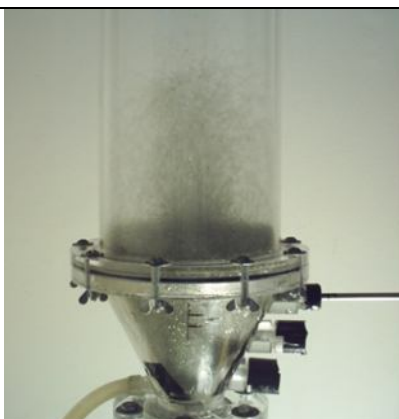
Figura 4.39 – Condição experimental com a sonda localizada a 1 cm do centro do leito de jorro, velocidade do ar de 36 m/s e altura da fonte detectada de 12 cm.
