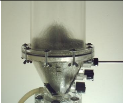
Figura 4.19 – Condição experimental com a sonda localizada no centro do leito de jorro, velocidade do ar de 30 m/s e altura da fonte detectada de 5,0 cm.
