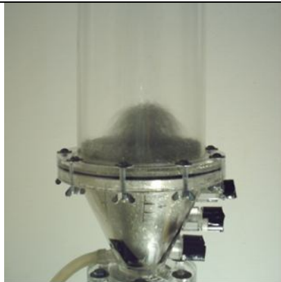
Figura 4.9 – Condição experimental sem a introdução da sonda, velocidade do ar de 27m/s e altura da fonte detectada de 4,0 cm.
