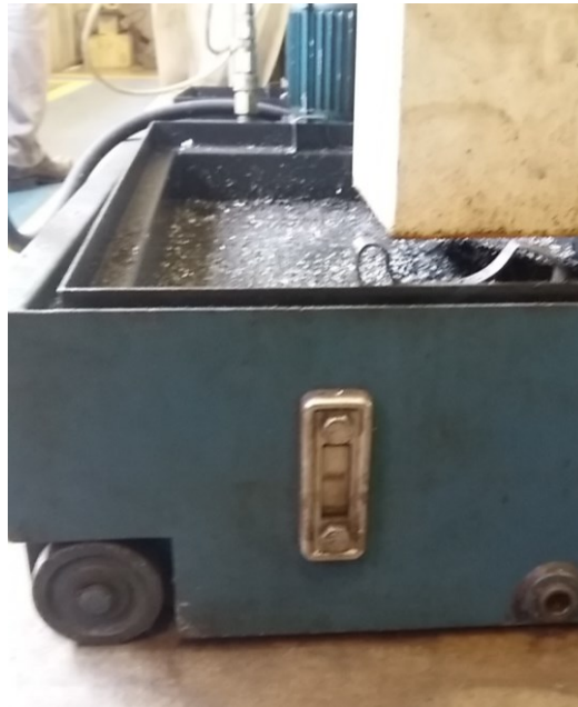
Figura 5.2 - Tanque de fluido refrigerante
