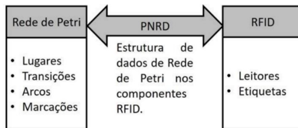
Figura 21 - PNRD integrando Redes de Petri e RFID
