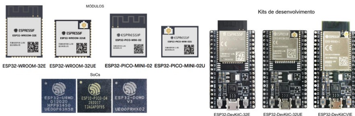
Figura 24 - Modelos de Microcontroladores ESP. Fonte: https://www.vidadesilicio.com.br , acessado em 22/09/2024
