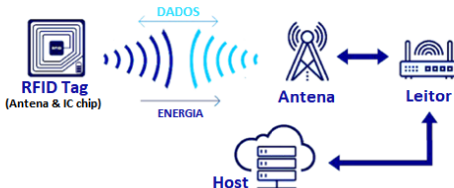
Figura 3 - Modo RFID Ativo. Fonte: < https://techblogpedia.com/ >, acesso em 15/09/2024
