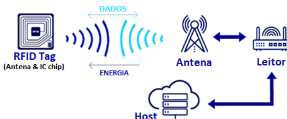
Figura 5 - Modo RFID Semi-passivo. Fonte: < https://techblogpedia.com/ >, acesso em 15/09/2024
