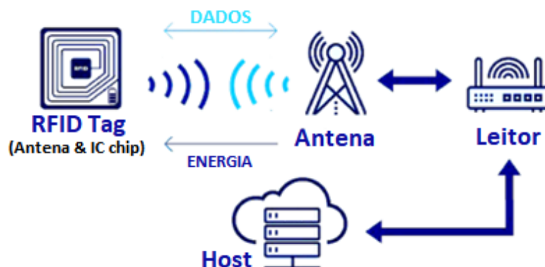
Figura 4 - Modo RFID Passivo. Fonte: < https://techblogpedia.com/ >, acesso em 15/09/2024
