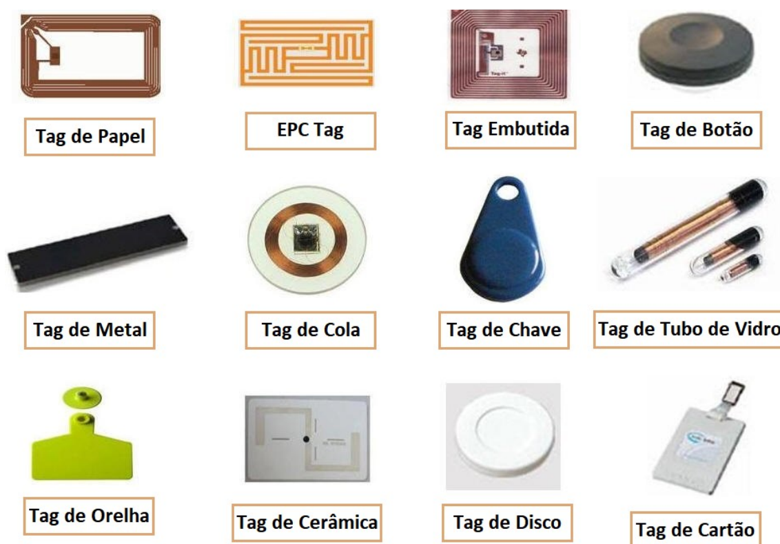
Figura 7 - Diferentes tipos de Etiquetas (TAG). Fonte: < https://www.indiamart.com/ >, acesso em 10/09/2024
