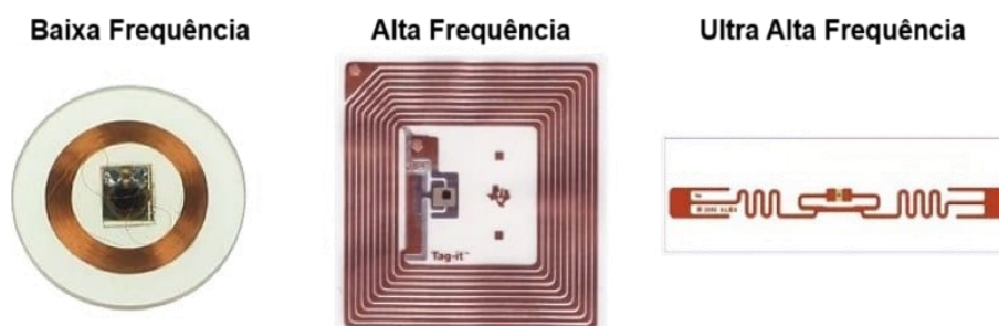
Figura 8 - Etiquetas de acordo com as faixas de frequência de operação. Fonte: < https://pt.aliexpress.com/ >, acesso em 15/09/2024
