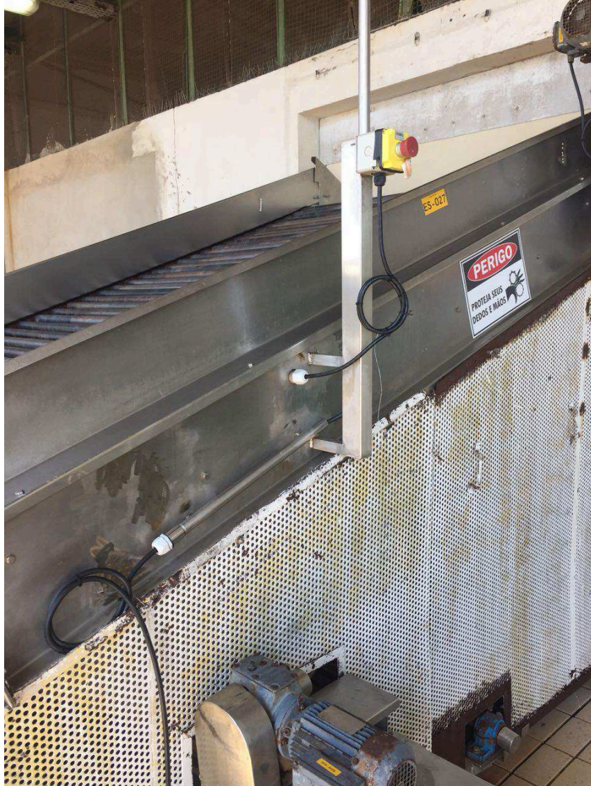
Fotografia 22. Esteira de entrada de frutos - dispositivos de parada de emergência direito.
