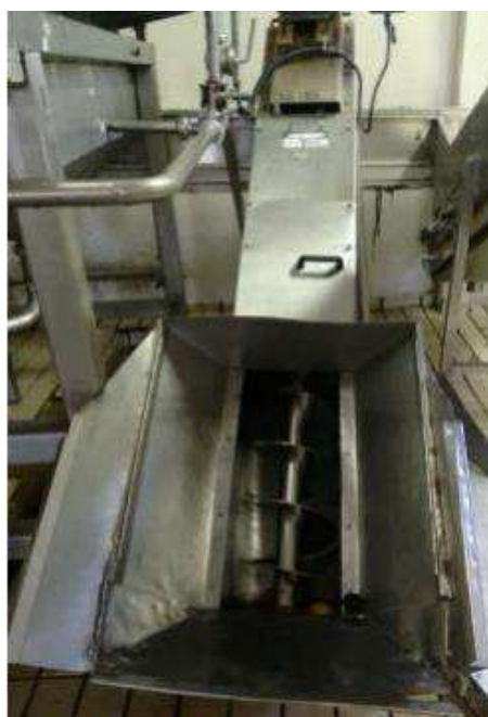
Fotografia 12. Esteira de saída de resíduo.
