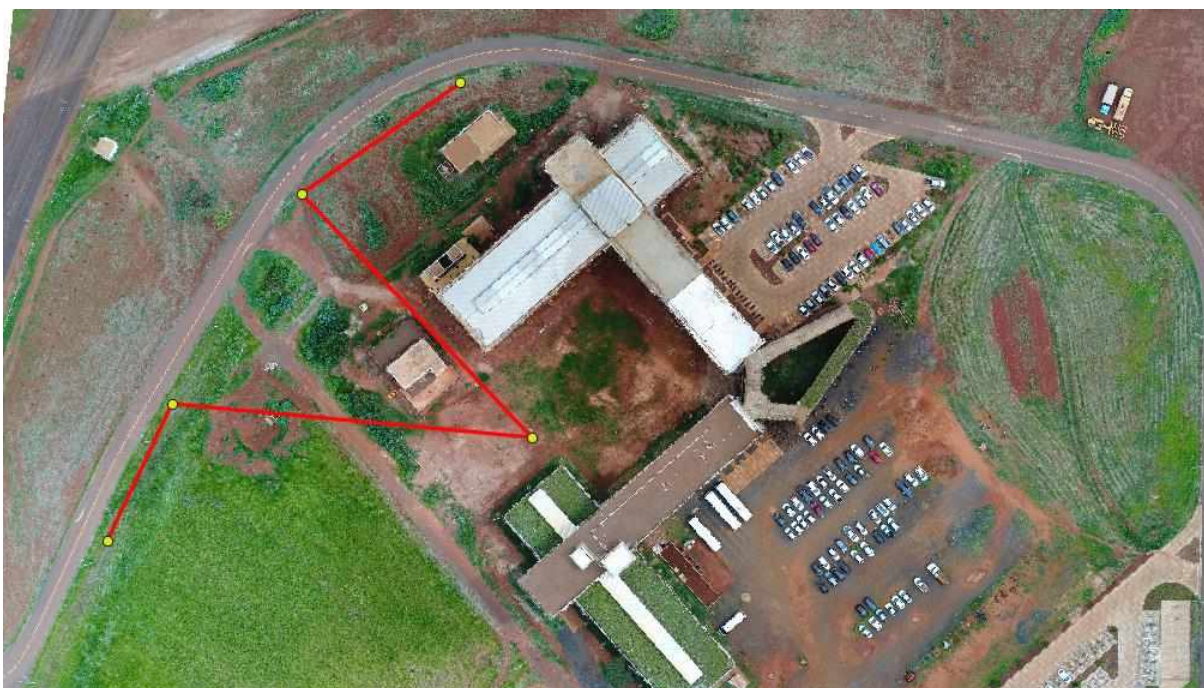
Figura 11 – Croqui da poligonal enquadrada utilizada para apoio das irradiações.
