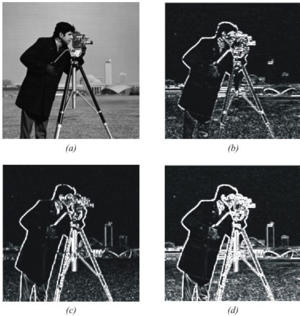
Figura 2.8 – Aplicação dos operadores de Sobel. (a) imagem original; (b) componente G_x ; (c) componente G_y ; (d) gradiente da imagem original.
