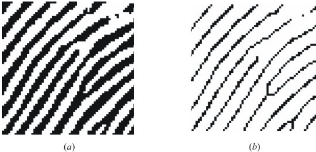
Figura 3.22 – (a) Imagem original; (b) imagem afinada pelo o algoritmo de afinamento.
