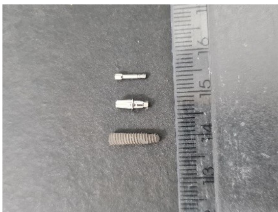
Figura 3: De baixo para cima, a imagem mostra respectivamente: implante, munhão universal e parafuso para aparafusamento do munhão universal no implante, ao lado de régua milimetrada, em que é possível observar o reduzido diâmetro do implante (2,9mm) e dos seus componentes.
