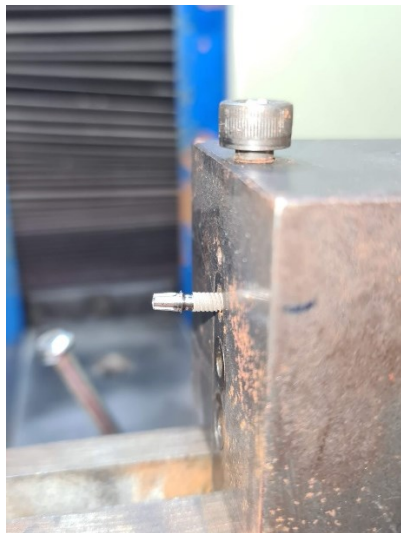
Figura 6: Posicionamento do sistema pilar/implante na estativa metálica, com a cervical do implante a 4mm de distância da estativa.
