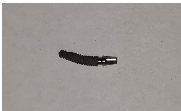
Figura 11: Sistema pilar/implante deformado e removido da estativa metálica após testagem
