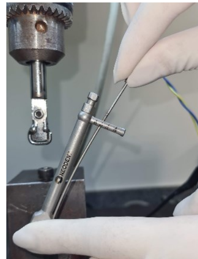
Figura 7: Instalação do implante na estativa com torquímetro, com torque de 20 N, conforme orientado pelo fabricante
