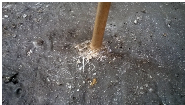
Figura 5.11 – Vedação do furo com cola quente.
