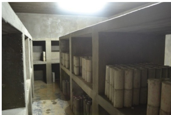
Figura 2.1 – Câmara úmida para cura de corpos de prova.
