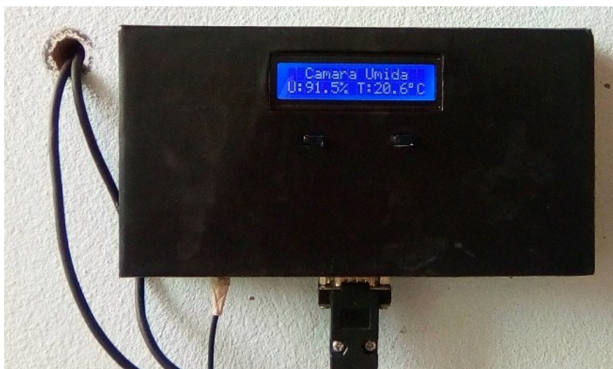
Figura 5.6 – Central exibindo as informações de umidade e temperatura dentro da câmara úmida.
