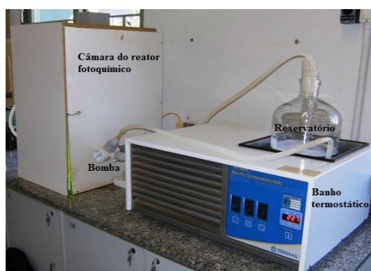
Figura 11. Sistema fotocatalítico utilizado em laboratório para a fotodegradação do glifosato em escala de bancada.
