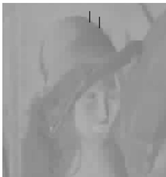
Figura 4-74 - Efeito de blockiness horizontal do JPEG padrão.
