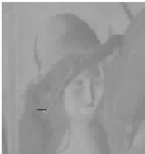
Figura 4-72 - Efeito de blockiness vertical do JPEG padrão.
