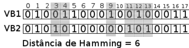
Figura 4.14: Distância de Hamming entre dois vetores de bits diferentes.
