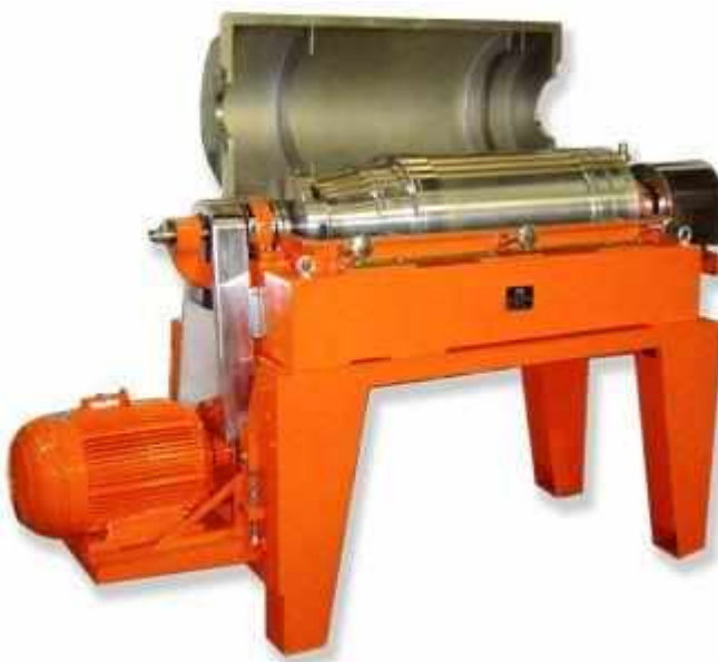
Figura 2.2. Centrífuga decantadora pertencente ao Grupo Sigma S.R.L.
