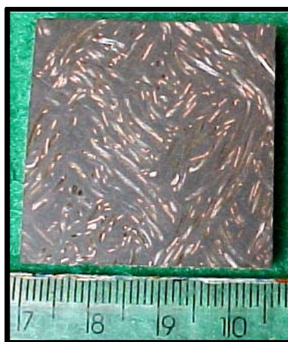
Figura 6.2: Amostra de revestimento tipo D utilizada para a caracterização topográfica na condição de retificação industrial.
