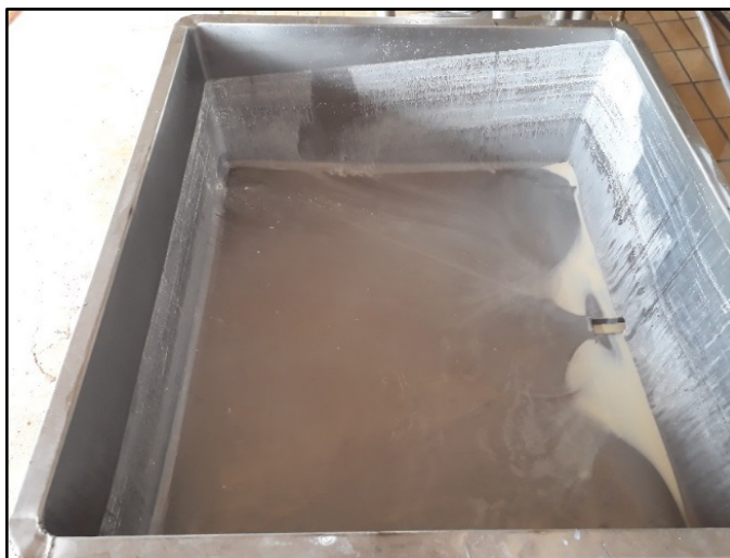
Figura 49 - Tanque de recebimento de leite in natura (Cru)
