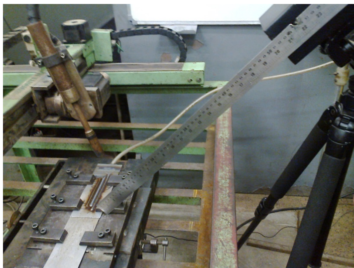
Figura 46 - Distância entre tocha e corpo de prova soldado
