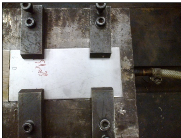
Figura 36 - Montagem / Gabaritação do corpo de prova
