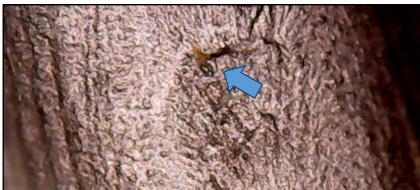
Figura 63 - Matéria orgânica aderida ao corpo de prova E4
