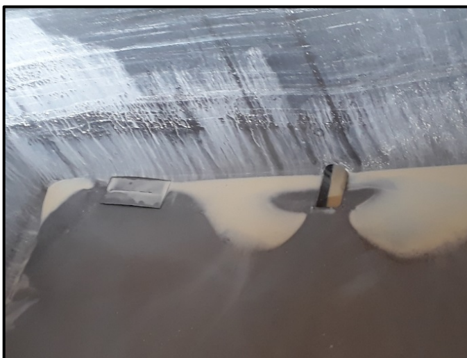
Figura 50 - Corpos de prova soldados e inserido em tanque recebimento
