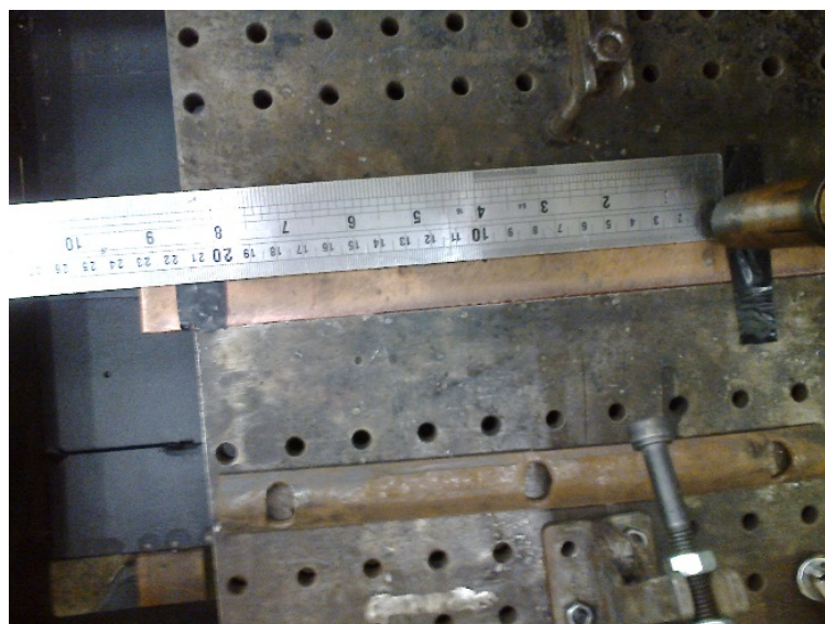
Figura 33 - Calibração da Mesa Coordenada
