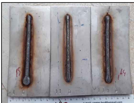
Figura 38 – Procedimento de marcação dos corpos de prova em triplicata e o respectivo nível de energia adotado.
