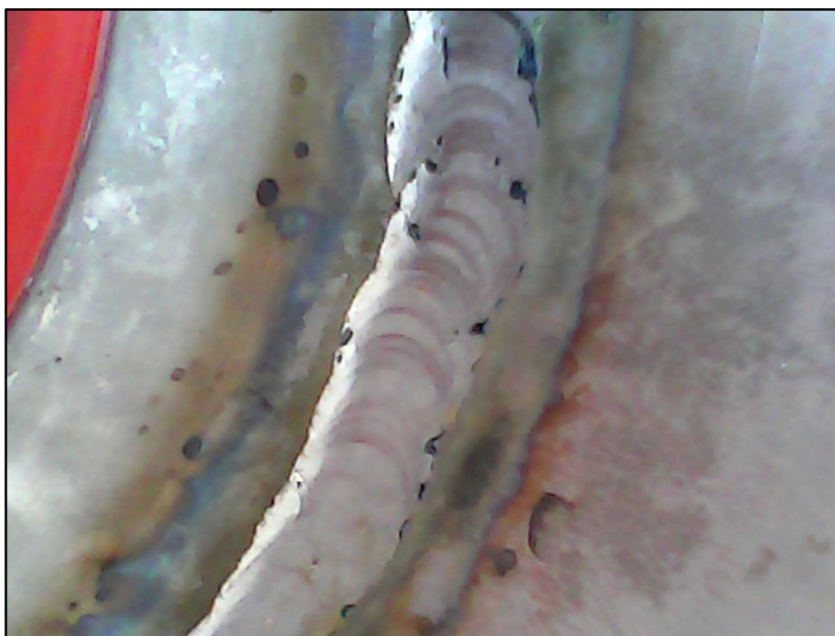
Figura 55–Cordão de solda visualizado pelo Boroscópio. Reforço de raiz.
