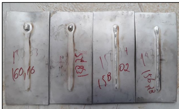
Figura 39 - Reforço de raiz nos níveis de aporte de energia: E1, E2, E3 e E4.
