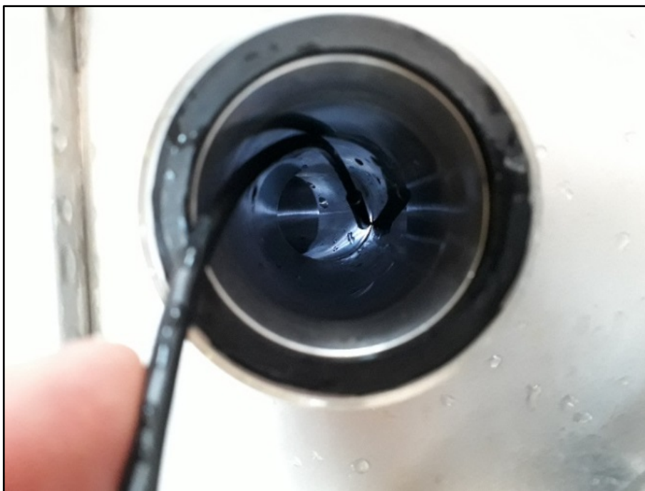
Figura 51–Boroscópio e inspeção em tubo com solda (Autor).
