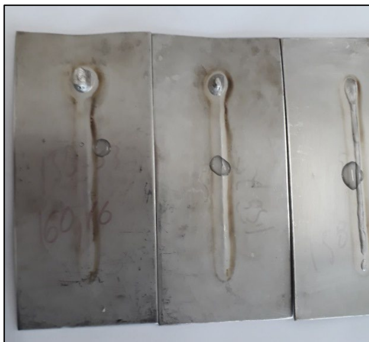
Figura 59– Decapagem química dos corpos de prova.
