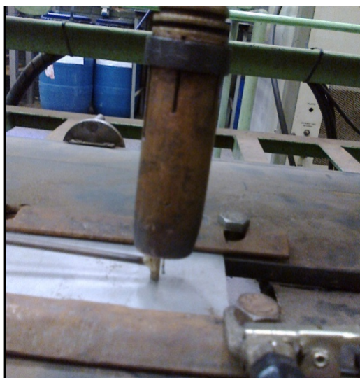
Figura 32 - Determinação do parâmetro DBCP com uso de gabarito para o processo de soldagem
