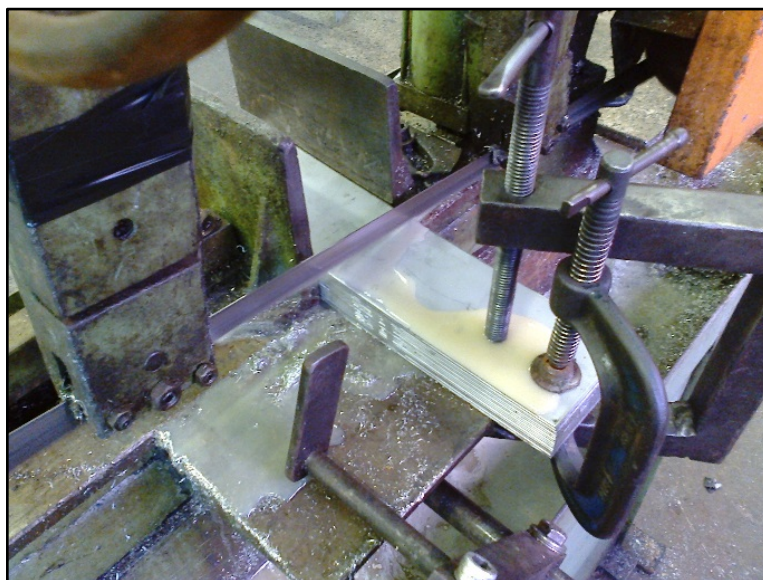
Figura 26 - Processo de serragem dos corpos de prova
