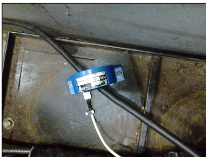
Figura 31 - Sensor Hall instado para aquisição de sinais Corrente (I) e Tensão (V)
