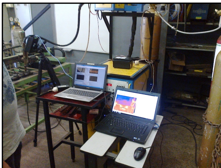
Figura 45 - Montagem da câmera térmica e software para aquisição das imagens
