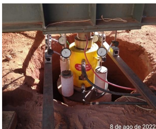
Figura 25 – Prova de carga em estaca isolada com solo em estado inundado.
