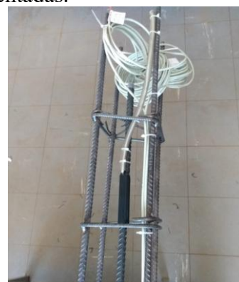
c) Barra instrumentada fixada na armação da estaca
