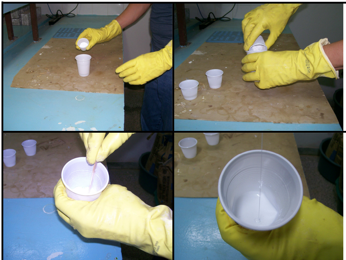
Figura 27 – Etapas da mistura do \text{TiO}_2 e pó de vidro à resina epóxi
