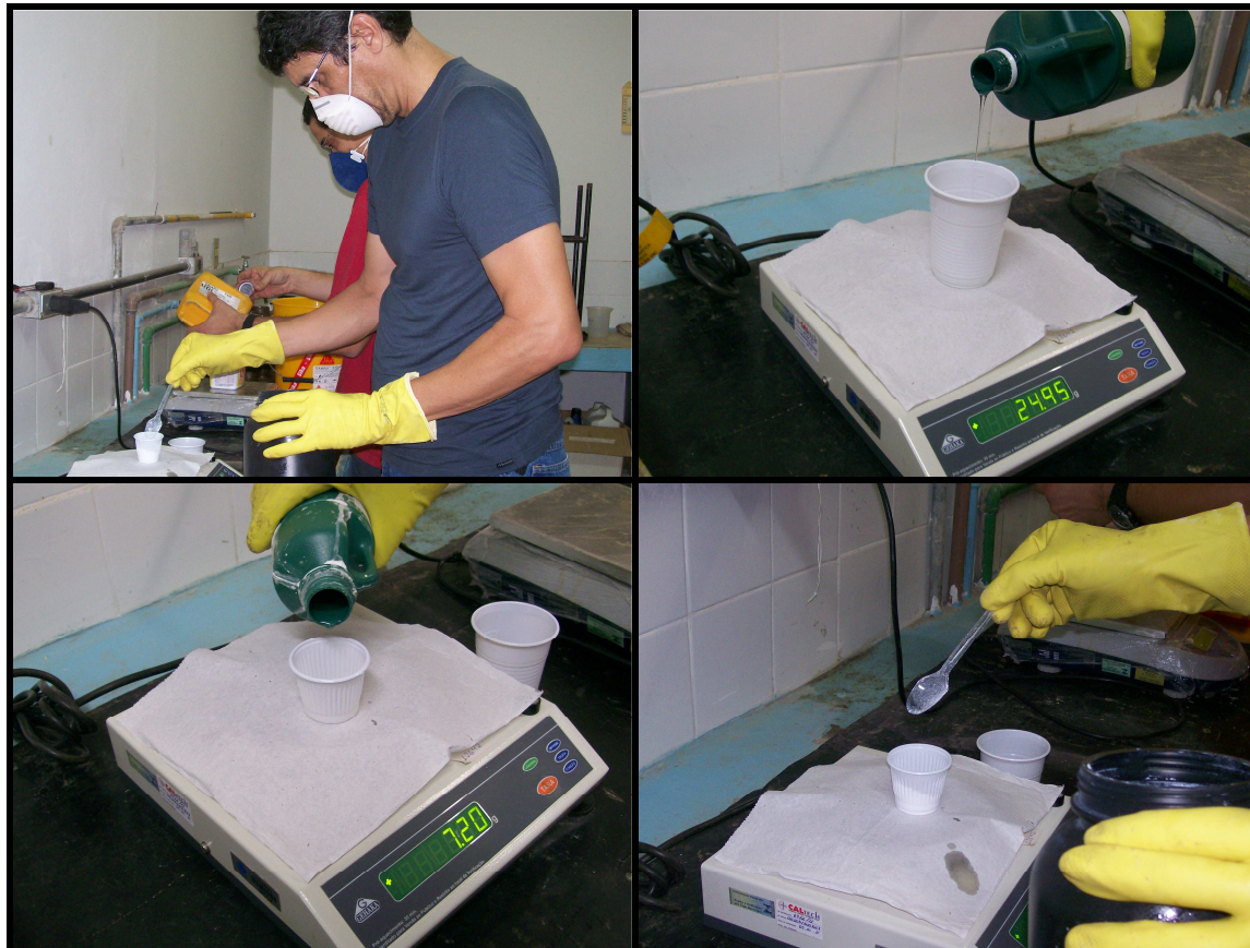
Figura 26 – Pesagem da resina, catalisador, \text{TiO}_2 e pó de vidro
