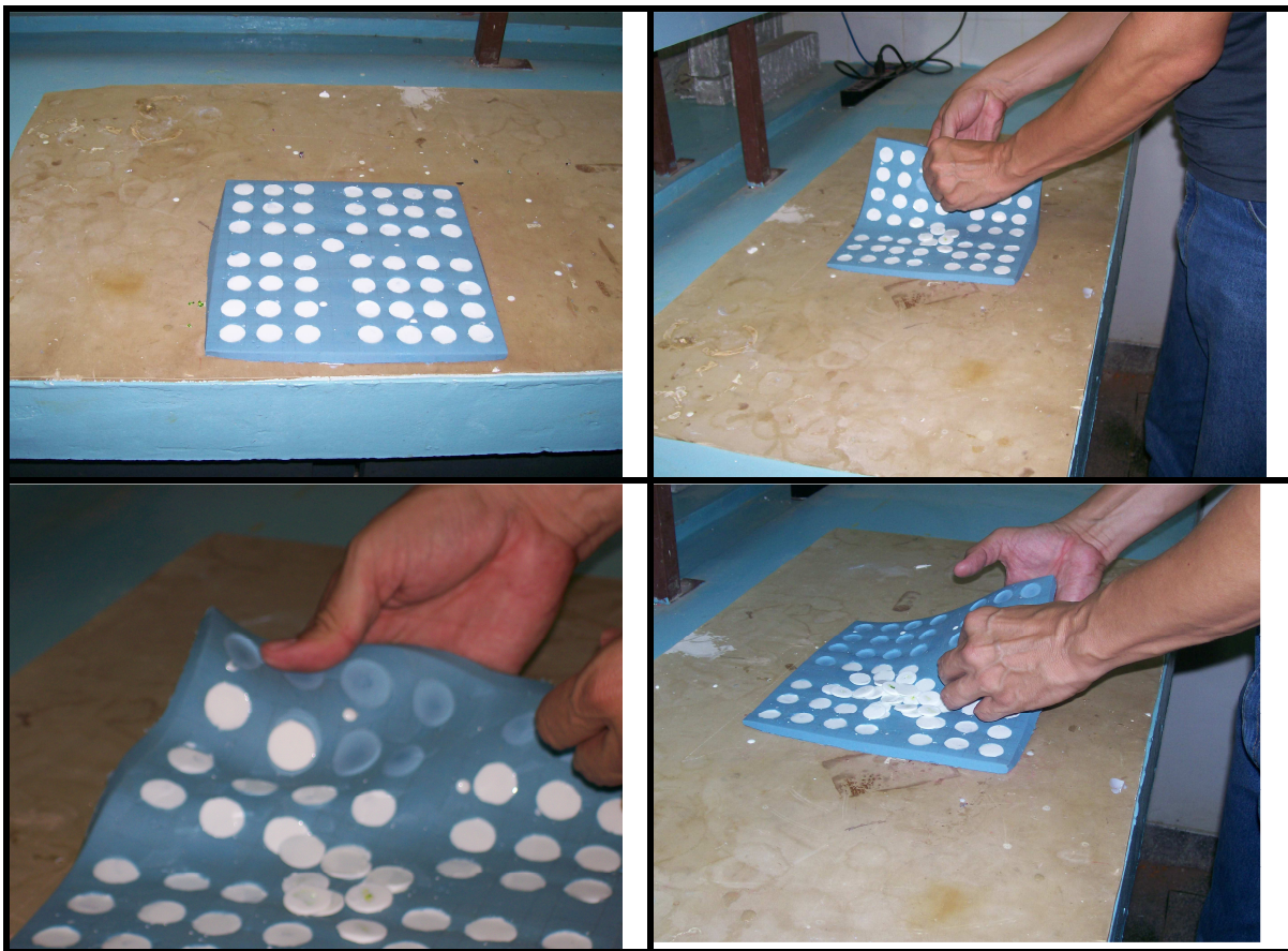
Figura 29 – Desmoldagem das pastilhas
