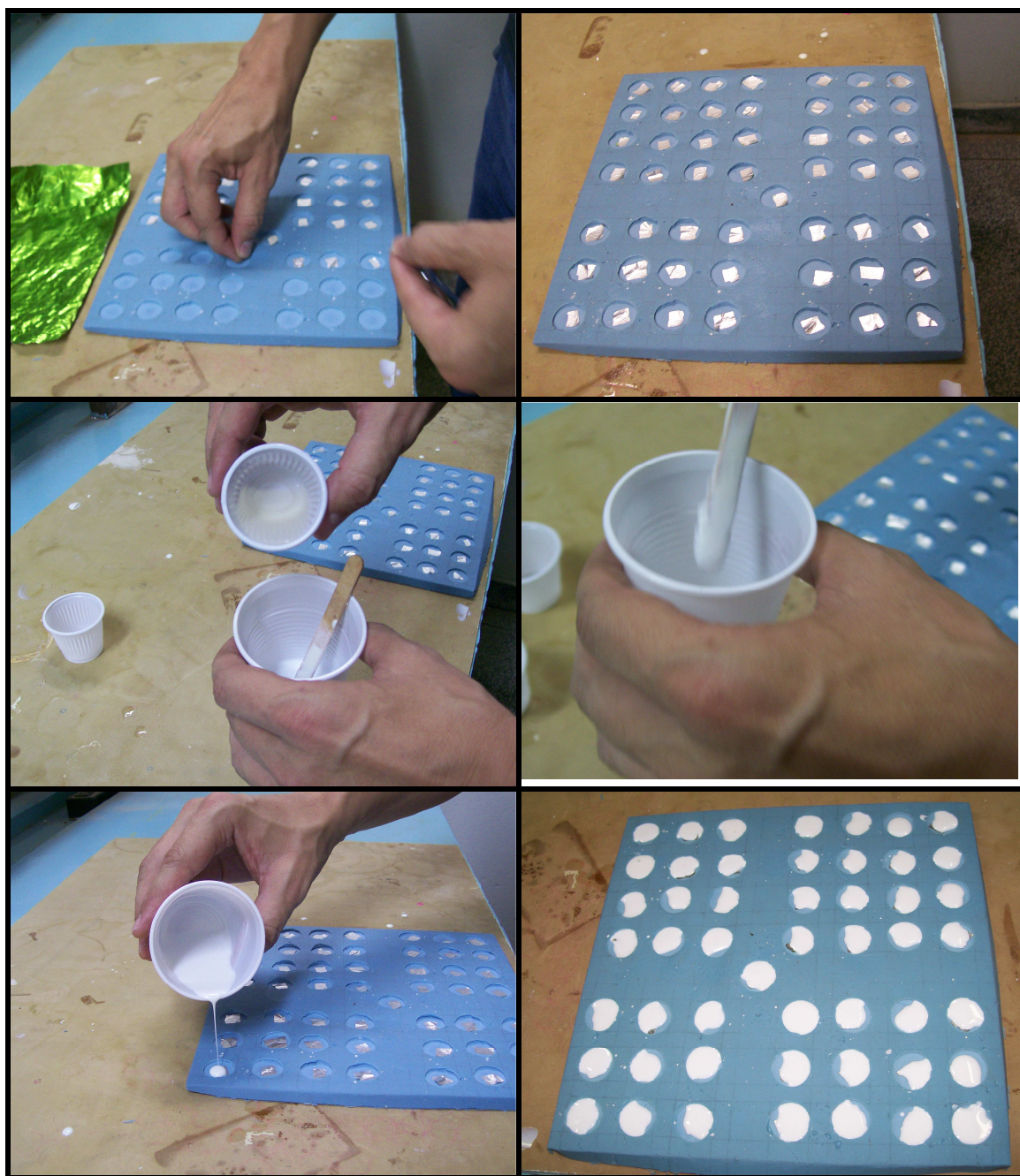
Figura 28 – Processo de moldagem das pastilhas
