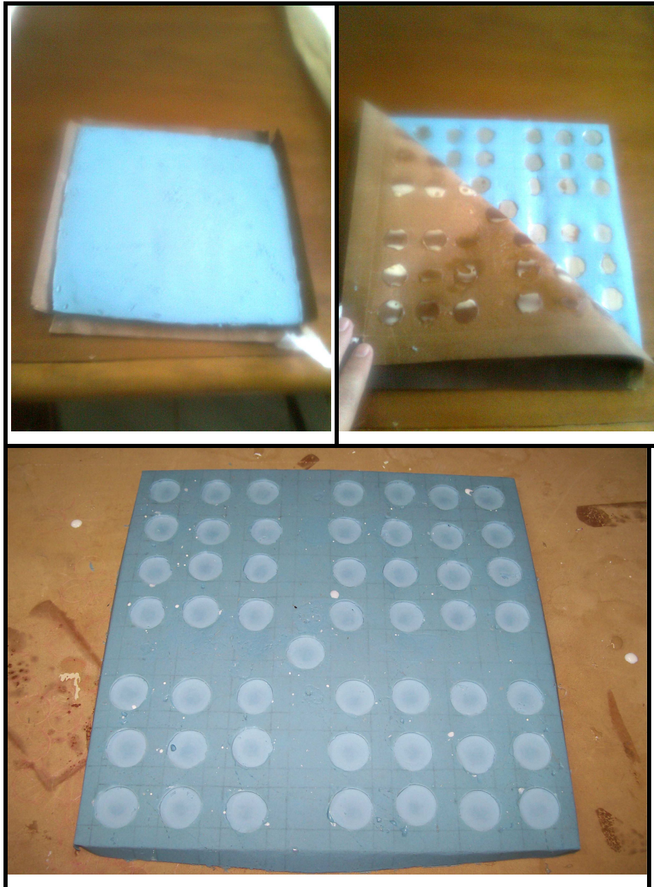
Figura 24 – Processo de moldagem da forma de silicone
