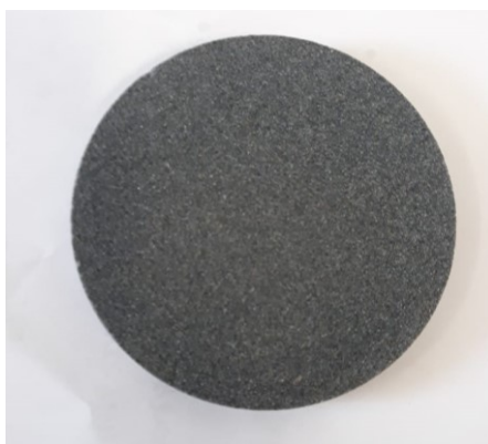
Figura 3.2 – Membrana Ofite 50 micras.
