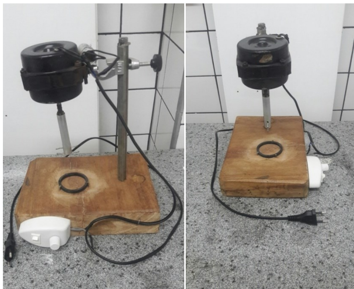
Figura 11. Agitador mecânico construído para realização das reações de transesterificação.
