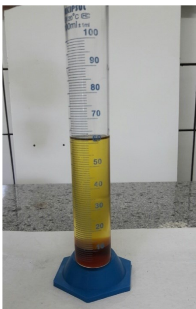
Figura 13. Sistema de decantação contendo biodiesel na parte superior e glicerina na parte inferior.
