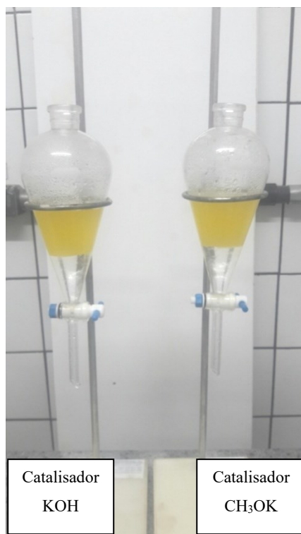
Figura 20. Sistema após sucessivas lavagens contendo Biodiesel na parte superior e interface nitidamente limpa na parte inferior.
