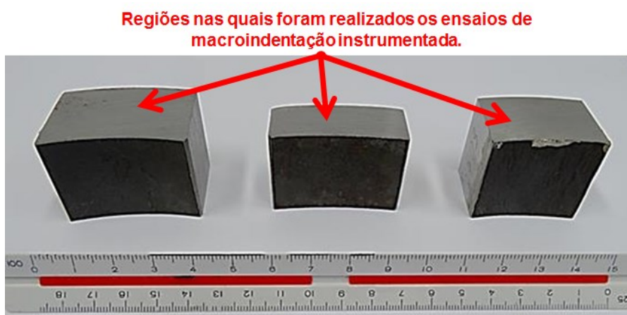
Figura 3.1 – Dimensões das amostras fornecidas pelo fabricante dos tubos e usadas nos ensaios de macroindentação instrumentada.
