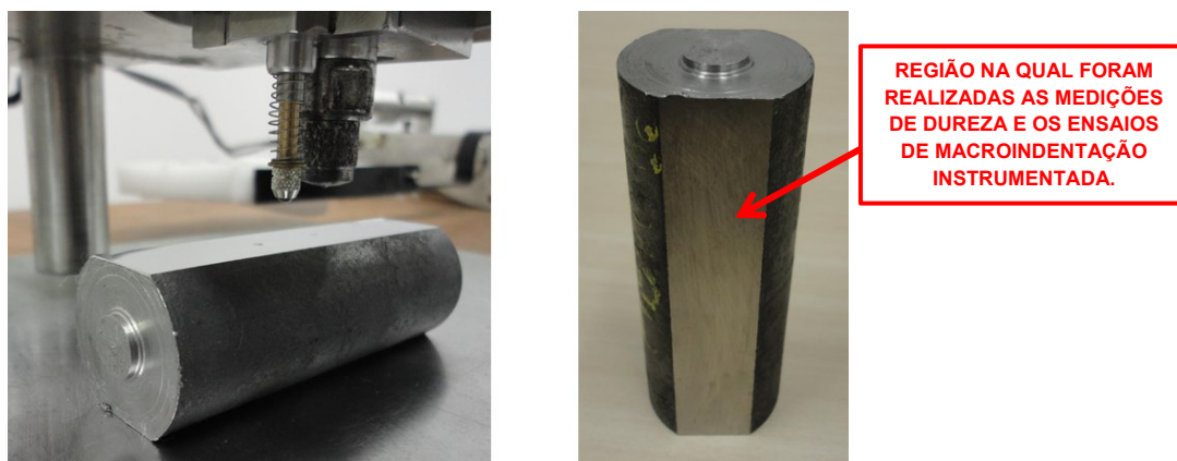
Figura 3.16 – Ilustração da realização dos ensaios de macroindentação instrumentada nos trechos removidos das barras dos lotes 2 a 5 do aço ABNT 8550 (foto da esquerda). Trecho usinado por fresamento (foto da direita), com remoção de 4 mm de material de ambos os lados, correspondente ao corpo de prova 3 da Fig. 3.15.
