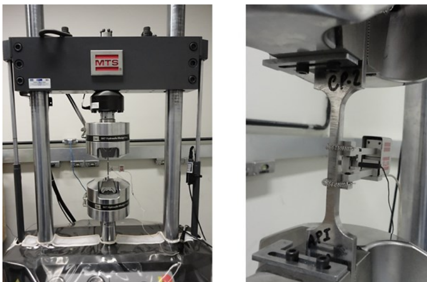
Figura 3.13 – Máquina de tração utilizada nos ensaios de tração uniaxial (foto da esquerda) e posicionamento do extensômetro no corpo de prova (foto da direita).
