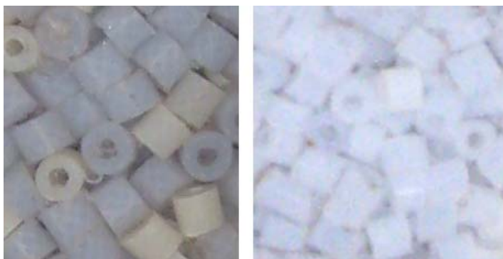
Figura 3.3- Material suporte dos reatores aeróbio e anaeróbio respectivamente.
