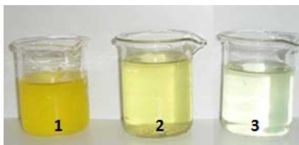
Figura 4.4 – Foto ilustrativa do experimento 4 (2 g/L de acetato de sódio, 1 g/L de cloreto de amônio e 120 mg/L de Cr (VI)), após 96 horas. 1- Entrada (120 mg/L )
