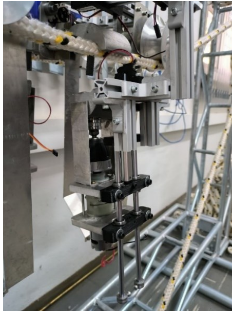
Figura 38 - Flambagem no conjunto de parafusação.
