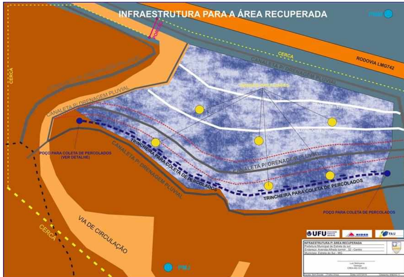
Figura 13: Cenário da infraestrutura superficial da área a ser recuperada. Destaque para as canaletas para drenagem pluvial, rede de gazes e trincheira para coleta percolada com os poços de coleta de percolados em cada extremidade.
