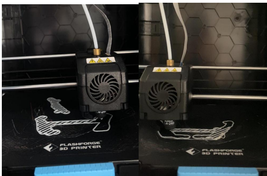
Figura4. Momento em que a impressora começa a deposição do filamento aquecido para confecção do biomodelo.
