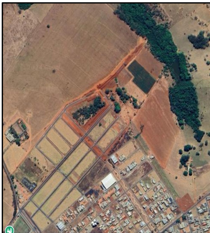
Figura 17 - Área de Loteamento implementado mostrando canais de drenagem com vegetação ripária ao fundo
