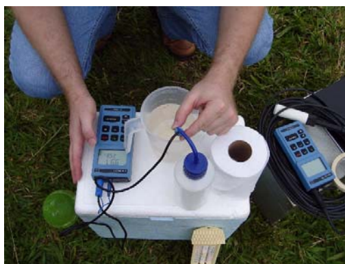
Figura 3.32: Leitura de pH e condutividade, pHmetro Schott
