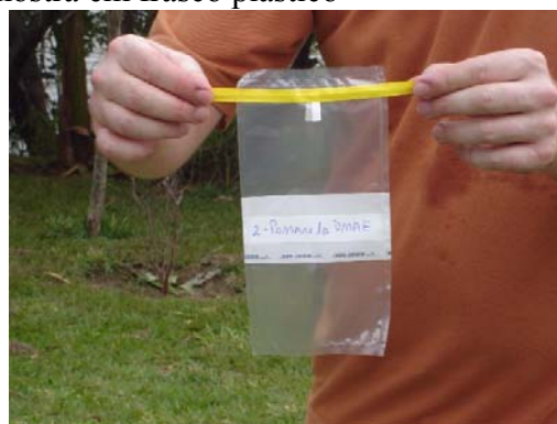
Figura 3.22: Saquinho estéril para acondicionamento de amostra para análise microbiológica
