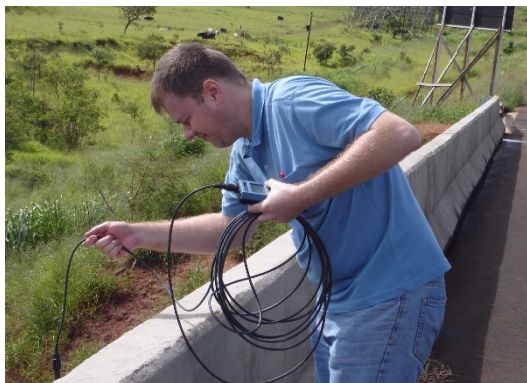
Figura 3.33: Posicionamento de sonda do oxímetro para determinação de OD e temperatura da água (ponte BR 050)
