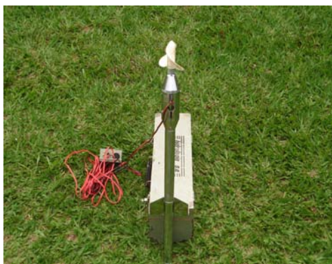
Figura 3.26: Molinete utilizado na determinação de vazão
