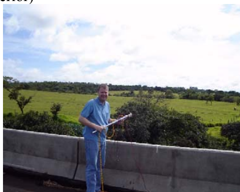
Figura 3.30: Divisão da seção transversal do rio Uberabinha, ponte BR 050, para determinação de vazão
