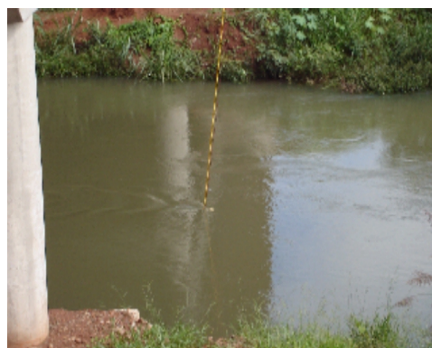
Figura 3.29: Posição do molinete no rio (ponte BR 050) na determinação do número de rotações da hélice (vista lateral)
