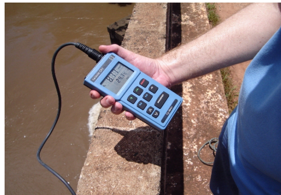
Figura 3.34: Oxímetro Schott, leitura de OD e temperatura da água (Distrito de Martinésia)
