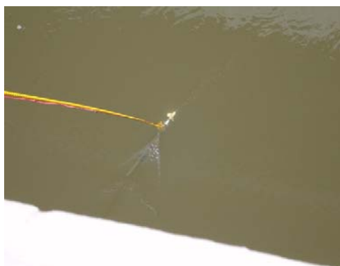
Figura 3.28: Posição do molinete no rio (ponte BR 050) na determinação do número de rotações da hélice (vista superior)
