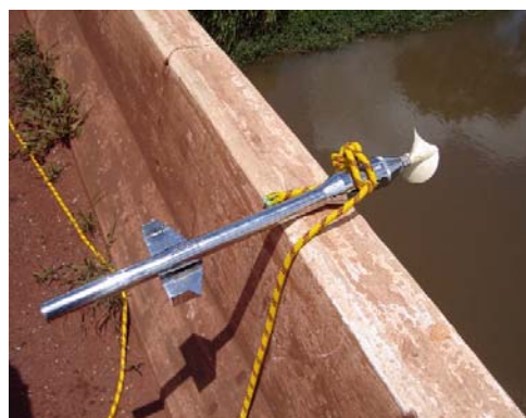
Figura 3.27: Molinete utilizado na determinação de vazão
