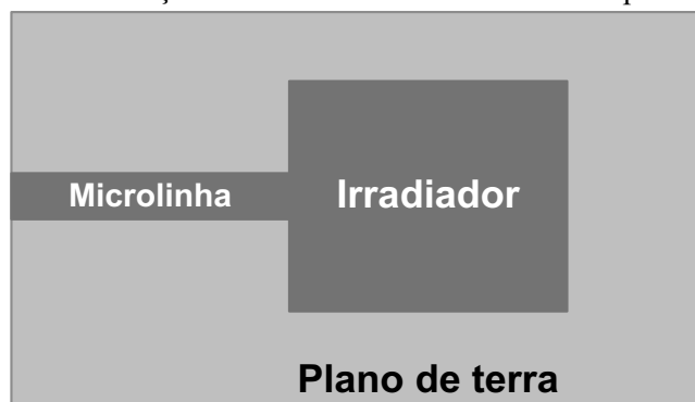
Figura 3.4 - Antena com alimentação de linha de microfita no mesmo plano do elemento irradiador
