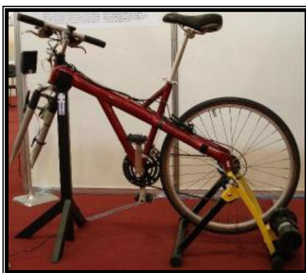
Figura 14 – Bicicleta do projeto com suporte de treino acoplado ao motor (SCHALCO et.al, 2007)
