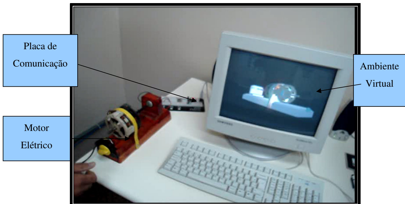
Figura 45: Ambiente Virtual em uso acionado pelo motor real através da protoboard.
